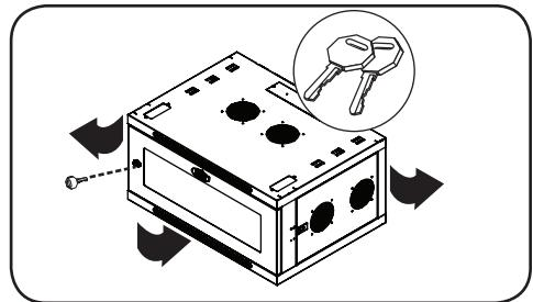
Cada panel lateral se asegura usando una palanca en "L" en el lado interno del gabinete.
