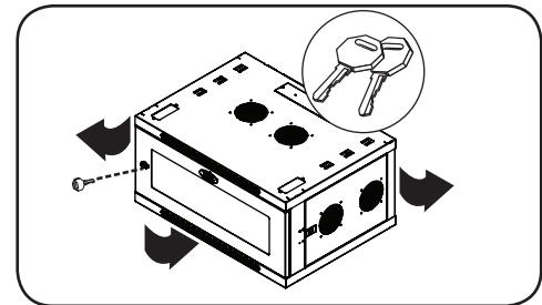
Chaque panneau latéral se verrouille au moyen d'un levier en forme de L à l'intérieur du boîtier.
