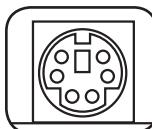
**Puerto PS/2:** Use este puerto para conectar un sensor ambiental ENVIROSENSE de Tripp Lite para proporcionar monitoreo remoto de temperatura/humedad y una interfaz de contacto seco para controlar y monitorear dispositivos de alarma, seguridad y telecomunicaciones.
