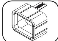
**Manguito de Clavija C20:** (Opcional) Use los manguitos plásticos C20 incluidos para asegurar las clavijas a los tomacorrientes. Acople el manguito a la clavija asegurándose que las pestañas de tiro permanezcan fuera de la clavija y que la sujeción sea segura. Para desenchufar correctamente el equipo, use las pestañas de tiro para retirar la clavija y el manguito del tomacorriente.
