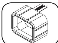
**Муфта разъема C20:** (опция) зафиксируйте разъемы в розетках при помощи входящих в комплект пластмассовых муфт под разъемы C20. Прикрепите муфту к разъему, убедившись в том, что ее язычки остаются за пределами разъема и плотно прилегают к нему. Для правильного отсоединения оборудования следует вынимать разъем с муфтой из розетки, держась за язычки.
