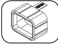
**Manchon de fiche C20 :** (facultatif) Utiliser les manchons en plastique C20 inclus pour retenir les fiches aux prises de courant. Fixer le manchon à la fiche en s'assurant que les languettes de préhension demeurent à l'extérieur de la fiche et qu'il repose solidement en place. Pour débrancher correctement l'équipement, utiliser les languettes de préhension pour retirer la fiche et le manchon de la prise de courant.
