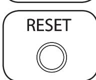
**Кнопка перезапуска SNMP:** для перезагрузки сетевой карты PDU нажмите кнопку перезапуска и удерживайте ее в течение 3 секунд. Перезагрузка сетевой карты не приводит к сбросу сетевых настроек или отключению электропитания переменного тока. Кнопка сбраса утоплена. Для ее нажатия используйте канцелярскую скрепку или другой подходящий предмет.
