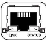
**Ethernet-порт:** используйте этот разъем типа RJ-45 для подключения PDU к сети с помощью стандартного соединительного кабеля типа Ethernet. СИД Link (Связь) **A** и СИД Status (Статус) **B** используются для обозначения нескольких рабочих режимов, как показано в приведенной ниже таблице. *Этот порт не поддерживает подключения по технологии PoE (питание по кабелю витой пары).*
