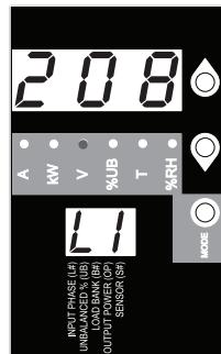
\* Примечание. Для моделей на 208 В, отображаемые значения напряжений представляют собой межфазные напряжения (т.е. отображаемое значение L1 будет соответствовать напряжению L1-L2). Для моделей на 400 В, отображаемые значения напряжений представляют собой межфазные и нейтраль напряжения (т.е. отображаемое значение L1 будет соответствовать напряжению L1-N).
