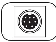
**Port PS/2 :** Utiliser ce port pour connecter un capteur environnemental ENVIROSENSE de Tripp Lite pour fournir une surveillance à distance de la température/humidité et une interface de contact sec pour contrôler et surveiller les dispositifs d'alarme, de sécurité et de télécommunication. Visitez [www.tripplite.com](http://www.tripplite.com) pour de plus amples informations sur la façon de commander. *Remarque : Ne pas brancher un clavier ou une souris à ce port.*
