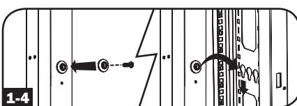
Nota: Cerciórese de insertar los dos botones en en cualquier orificio superior en **cada extremo** del PDU o en el orificio inferior en **cada extremo** del PDU.
