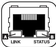
**Port Ethernet :** Utiliser cette prise RJ-45 pour brancher la PDU au réseau avec un cordon de raccordement Ethernet standard. Le voyant DEL du lien **A** et le voyant DEL de l'état **B** indiquent plusieurs conditions de fonctionnement comme l'indique le tableau ci-dessous. *Ce port n'est pas compatible avec les applications nécessitant l'alimentation par Ethernet (PoE).*
