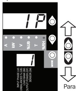
En cualquier punto, oprimir por 1/2 segundo simultáneamente ambos botones de flecha muestra la dirección IP de la unidad en la pantalla de 2 dígitos.
