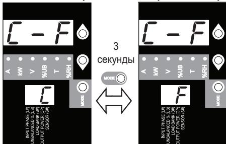
Для переключения между опциями удерживайте кнопку выбора режима (MODE) нажатой в течение 3 секунд. Буква, отображаемая на 2-разрядном дисплее, обозначает выбранную единицу измерения (С – Цельсий, F – Фаренгейт).
