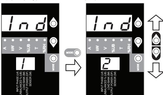
Для переключения между опциями удерживайте кнопку выбора режима (MODE) нажатой в течение 3 секунд. Цифра, отображаемая на 2-разрядном дисплее, означает выбранный тип маркировки: 1=стандартная, 2=альтернативная
