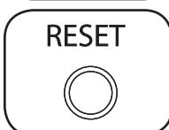
**Bouton de réinitialisation SNMP :** Appuyer sur le bouton de réinitialisation pendant 3 secondes pour redémarrer la carte de réseau de la PDU. Le fait de redémarrer la carte de réseau n'effacera pas les paramètres du réseau et ne va pas interrompre l'alimentation CA. Le bouton de réinitialisation est encastré. Utiliser un trombone ou un autre objet approprié pour l'enfoncer.
