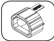
**Manchons de fiche C14 :** (facultatif) Utiliser les manchons en plastique C14 inclus pour retenir les fiches aux prises de courant. Fixer le manchon à la fiche en s'assurant que les languettes de préhension demeurent à l'extérieur de la fiche et qu'il repose solidement en place. Pour débrancher correctement l'équipement, utiliser les languettes de préhension pour retirer la fiche et le manchon de la prise de courant.
