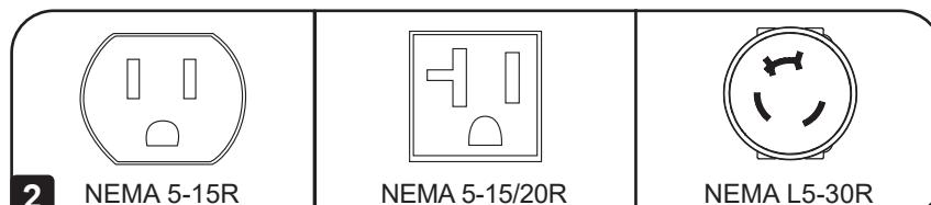
**2** Tomacorrientes (Varía según el Modelo): Durante la operación normal, los tomacorrientes distribuyen energía CA a los equipos conectados.
