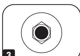
**3** Breaker: Si la corriente consumida por el equipo conectado al PDU excede la Especificación de Corriente Máxima, el breaker se disparará para evitar posibles daños. Cuando se dispara un breaker, su perno saltará. Desconecte el equipo en exceso y permita que el breaker se enfrie por al menos un minuto antes de oprimir el perno para restablecer el breaker.
