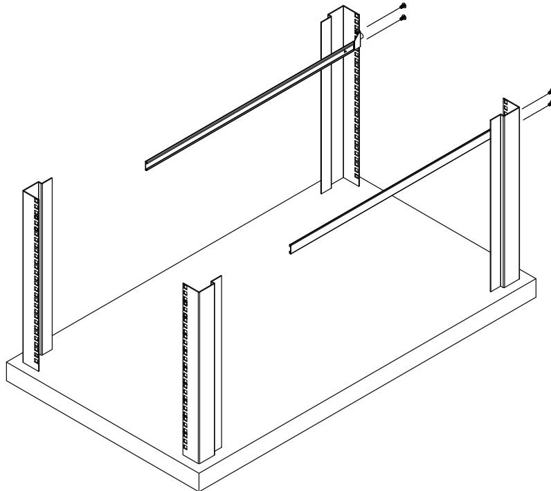
**Remarque :** Au moment de fixer le rail, s'assurer que la section triangulaire de l'arrière des rails de montage de la trousse de montage 2-en-1 est orientée vers le haut et que le côté marqué « L » ou « R » est tourné vers l'intérieur.
