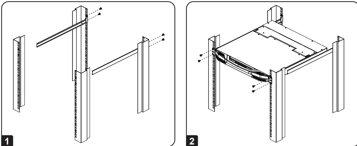
**1** Fije los soportes de instalación izquierdo y derecho a la parte posterior del rack. Use los cuatro tornillos incluidos para fijar los soportes de instalación en su lugar.
