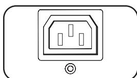
**Tomacorrientes IEC 60320 C13 (PDUMH15HVNET y PDUMH20HVNET):** Durante la operación normal, los tomacorrientes distribuyen energía de CA al equipo conectado. Cuando un tomacorriente está encendido, el LED asociado se ilumina.
