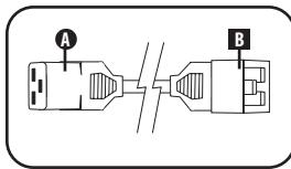
**Входной разъем питания переменного тока (мод. PDUMH20HVNED):** отсоединяемый шнур имеет разъем типа IEC 60320 C19 (**A**) и разъем типа IEC 60320 C20 (**B**).
