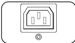
**Выходные розетки IEC 60320 C13 (для мод. PDUMH15HVNET и PDUMH20HVNET):** в штатном режиме работы эти выходные розетки распределяют мощность переменного тока между подключенными к ним элементами оборудования. Во время нахождения той или иной розетки под напряжением горит связанный с ней светодиодный индикатор.
