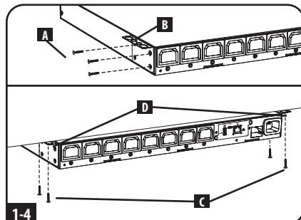
**1-5 Монтаж с уменьшенной глубиной:** с помощью 3 винтов **A** прикрепите оба укороченных монтажных кронштейна **B** к корпусу PDU, как показано на рисунке. Прикрепите PDU к устойчивой поверхности розетками вверх путем ввертывания двух или более винтов **C** (не входящих в комплект поставки) через монтажные кронштейны **D** в отверстия, расположенные в точках надежного крепления.
