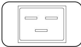
**Входной разъем питания переменного тока (мод. PDUMH20HVNED):** входной разъем IEC 60320 C20 используется для подключения отсоединяемого шнуря питания переменного тока.
