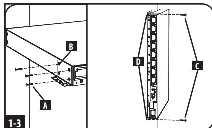
**1-4 Монтаж под прилавком:** с помощью 3 винтов **A** прикрепите оба укороченных монтажных кронштейна **B** к корпусу PDU, как показано на рисунке. Закрепите PDU под прилавком путем ввертывания двух или более винтов **C** (не входящих в комплект поставки) через монтажные кронштейны **D** в отверстия, расположенные в точках надежного крепления.
