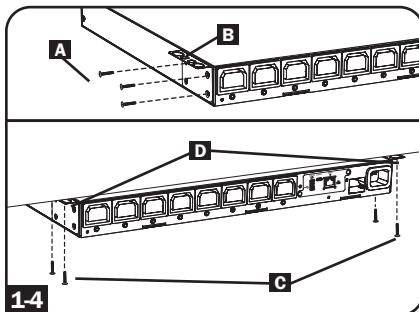
**1-5 Montage mit reduzierter Tiefe:** Verwenden Sie 3 Schrauben, **A** um jede der 2 kürzeren Montagehalterungen wie gezeigt **B** an der PDU zu befestigen. Montieren PDU auf einer stabilen Oberfläche mit den Ausgängen nach oben befestigen, indem Sie oder mehrere vom Benutzer bereitgestellte Schrauben **C** durch die Montagehalterungen **D** und in sichere Befestigungspunkte einführen.
