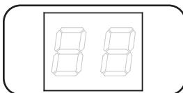
**Цифровой измеритель нагрузки (амперметр):** суммарный электрический ток, потребляемый подключенным оборудованием, отображается на дисплее измерителя в амперах.
