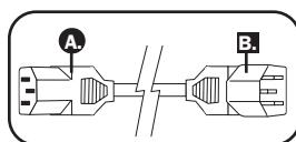
**AC-Eingang Netzkabel (Modell PDUMH15HVNET):** Das abnehmbare Kabel hat einen IEC 60320 C13 Stecker **A** und einen IEC 60320 C14 Stecker **B**.
