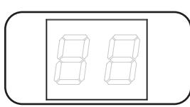
**Digitales Ladungsmessgerät (Ampermeter):** Der Gesamtstrom, der von den angeschlossenen Geräten aufgenommen wird, wird auf dem Messgerät in Ampere angezeigt.
