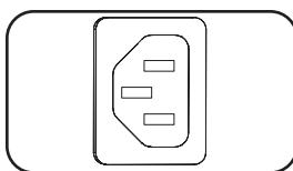
**Входной разъем питания переменного тока (мод. PDUMH15HVNED):** входной разъем IEC 60320 C14 используется для подключения отсоединяемого шнуря питания переменного тока.
