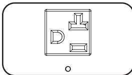
**Выходные розетки NEMA 5-15/20R (для мод. PDUMH20NET):** в штатном режиме работы эти выходные розетки распределяют мощность переменного тока между подключенными к ним элементами оборудования. Во время нахождения той или иной розетки под напряжением горит связанный с ней светодиодный индикатор.
