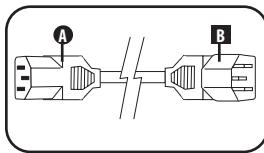
**Входной разъем питания переменного тока (мод. PDUMH15HVNED):** отсоединяемый шнур имеет разъем типа IEC 60320 C13 (**A**) и разъем типа IEC 60320 C14 (**B**).
