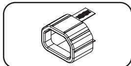
**Manchons de fiche C14 (facultatif) :** Utiliser les manchons en plastique C14 inclus pour retenir les fiches aux prises de courant. Fixer le manchon à la fiche en s'assurant que les languettes de préhension demeurent à l'extérieur de la fiche et qu'il repose solidement en place. Pour débrancher correctement l'équipement, utiliser les languettes de préhension pour retirer la fiche et le manchon de la prise de courant.
