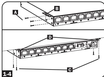
**1-5 Montage à profondeur réduite :** Utiliser 3 vis **A** pour fixer chacun des 2 supports de montage plus courts **B** à la PDU comme illustré. Monter la PDU à une surface stable avec les sorties tournées vers le haut en insérant au moins deux vis fournies par l'utilisateur **C** à travers les supports de montage **D** et dans les points de montage solides.
