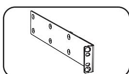
**Längere Montagehalterungen:** Verwenden Sie diese Halterungen, um die PDU horizontal in einem Standard-Rack oder Rack-Gehäuse zu montieren. Die Installationstiefe kann angepasst werden, indem die Halterungen in unterschiedlichen Positionen an der PDU installiert werden.
