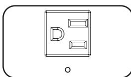
**Tomacorrientes NEMA 5-15R (PDUMH15NET):** Durante la operación normal, los tomacorrientes distribuyen energía de CA al equipo conectado. Cuando un tomacorriente está encendido, el LED asociado se ilumina.
