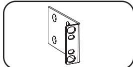
**Supports de montage plus courts :** Utiliser ces supports pour monter la PDU dans un bâti OU, dans une configuration murale ou sous le comptoir.
