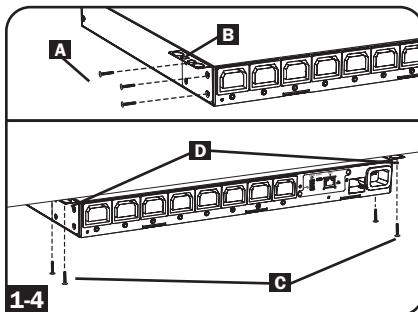
**1-5 Instalación de Profundidad Reducida:** Use 3 tornillos **A** para fijar cada uno de los 2 soportes pequeños de instalación **B** al PDU como se muestra. Instale el PDU en una superficie estable con los tomacorrientes viendo hacia arriba insertando 2 o más tornillos suministrados por el usuario **C** a través de los soportes de instalación **D** y en puntos seguros de instalación.
