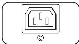
**Prises de sortie IEC 60320 C13 (PDUMH15HVNET et PDUMH20HVNET) :** Lors du fonctionnement normal, les prises de sortie distribuent une alimentation CA à l'équipement branché. Lorsqu'une sortie est sous tension, le témoin à DEL lui étant associé s'allume.
