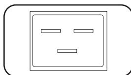
**AC-Eingang Leistung Eingang (Modell PDUMH20HVNET):** Der IEC 60320 C20 Eingang wird mit dem abnehmbaren AC-Eingang Netzkabel verbunden.
