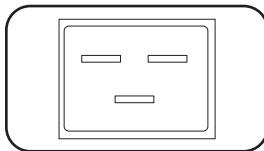
**Entrada de Energía de CA (Modelo PDUMH20HVNET):** La entrada IEC 60320 C20 se conecta al Cable de Alimentación de Entrada de CA desprendible.
