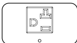
**NEMA 5-15/20R Ausgangsbuchsen (PDUMH20NET):** Im Normalbetrieb verteilen die Ausgangsbuchsen Wechselstrom an die angeschlossenen Geräte. Wenn eine Ausgang unter Spannung steht, leuchtet die zugehörige LED.
