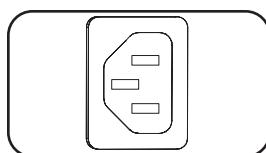
**AC-Eingang Leistung Eingang (Modell PDUMH15HVNET):** Der IEC 60320 C14 Eingang wird mit dem abnehmbaren AC-Eingang Netzkabel verbunden.
