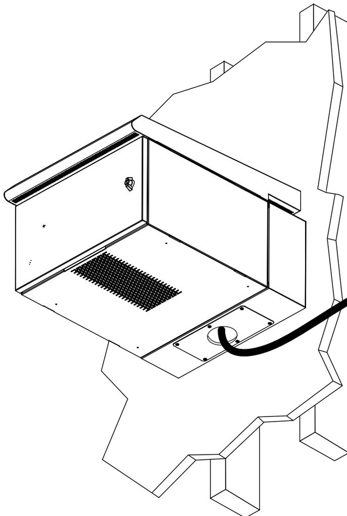
**Remarque :** Pour garder une capacité nominale NEMA, utiliser des raccords étanches dans les découpes au moment de connecter à la conduite. Les plaques passe-câbles pour accessoires avec les numéros de modèle SRGP1KO, SRGP2KO, SRGP3RM et SRGP4PLASTIC sont offertes (vendues séparément).
