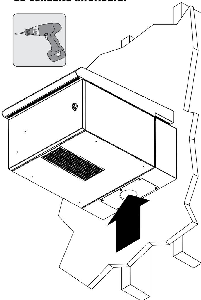
**Remarque :** Ce couvercle de conduit prend en charge un conduit de taille 2 maximum avec un trou de 2,5 po.
