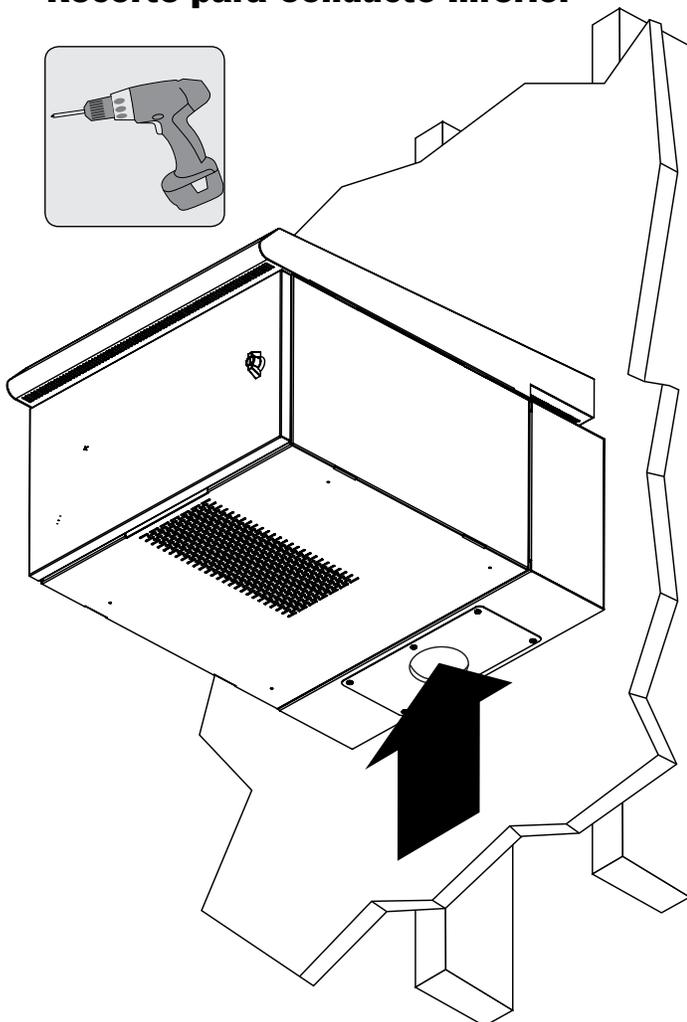
**Nota:** Esta tapa de conductos permite un tamaño comercial máximo de conductos 2 con orificio de 64 mm [2.5"].
