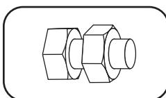
**Клемма заземления:** заземлите PDU с помощью этого винта.
