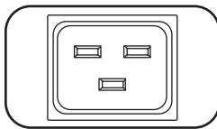
**Entrada de Alimentación IEC-320-C20:** La entrada de alimentación IEC se conecta al cable de alimentación incluido o a un cable de alimentación suministrado por el usuario.
