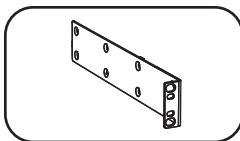
**Supports de fixation (1U) longs :** Utilisez ces supports pour fixer l'unité de distribution (1U) horizontalement dans un bâti ou un coffret standard. La profondeur de montage peut être ajustée en fixant les supports dans différentes positions sur l'unité.
