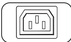
**Выходные розетки IEC-320-C13:** в штатном режиме работы эти 8 розеток распределяют мощность переменного тока напряжением 208/230 В между подключенными к ним элементами оборудования.
