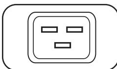
**Выходные розетки IEC-320-C19:** в штатном режиме работы эти 2 розетки распределяют мощность переменного тока напряжением 208/230 В между подключенными к ним элементами оборудования.
