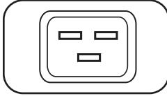
**IEC-320-C19-Ausgangsbuchsen:** Diese beiden Steckdosen verteilen 208/230V Wechselstrom an die angeschlossenen Geräte.
