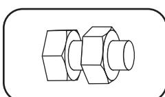
**Erdungsklemme:** Verwenden Sie diese Schraube, um die PDU mit der Erdung zu verbinden.
