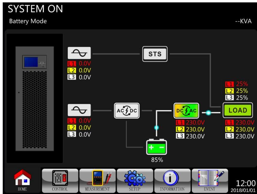
Étape 1: Appuyez sur le bouton marche/arrêt pendant deux secondes pour éteindre l'onduleur, ou utilisez le menu de contrôle du système.
