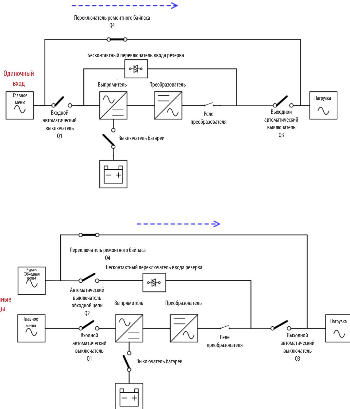
Схемы работы в режиме ремонтного байпаса
