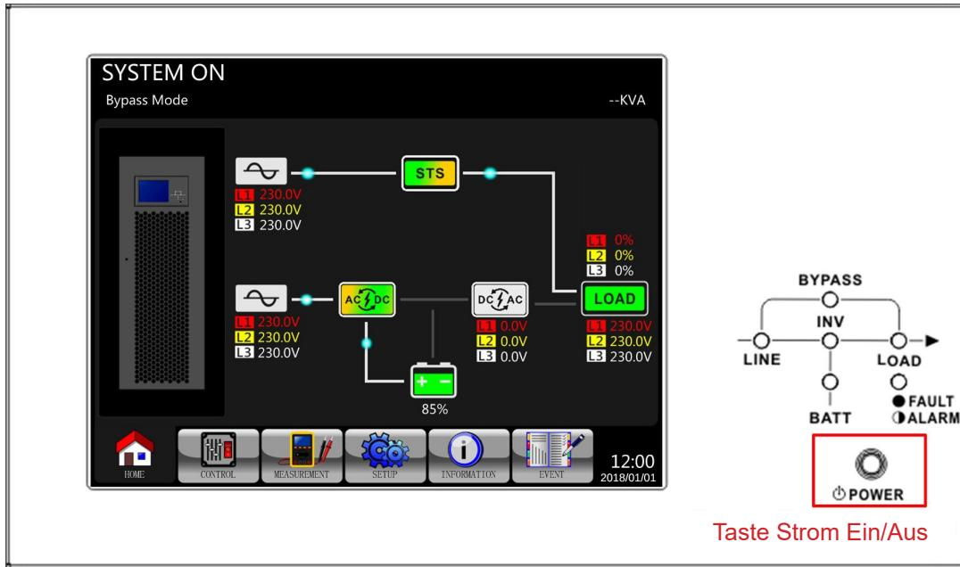
Schritt 7: Drücken Sie die EIN/AUS-Taste zwei Sekunden lang, bis ein Piepton zu hören ist, und lassen Sie dann los, um den Inverter zu starten.
