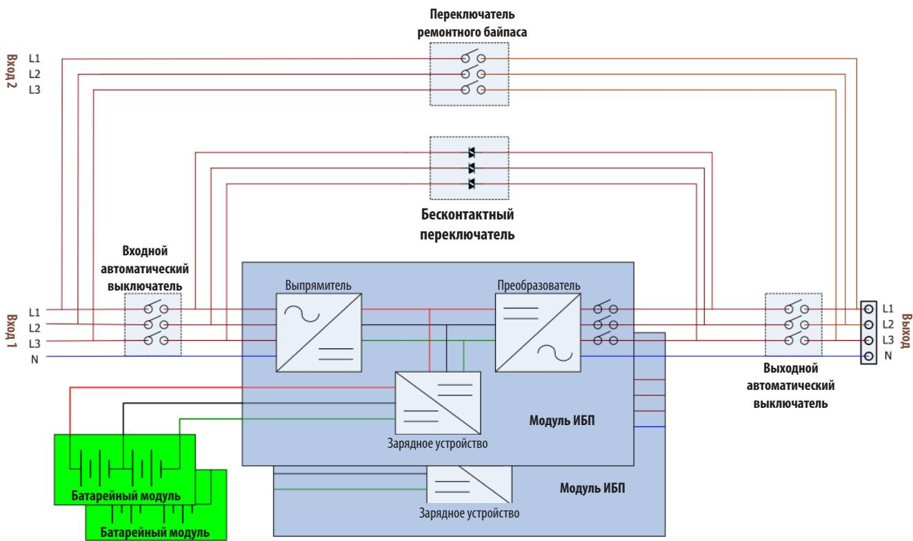
Рис. 6.1 Монтажная схема для стандартного ИБП с одиночным входом
