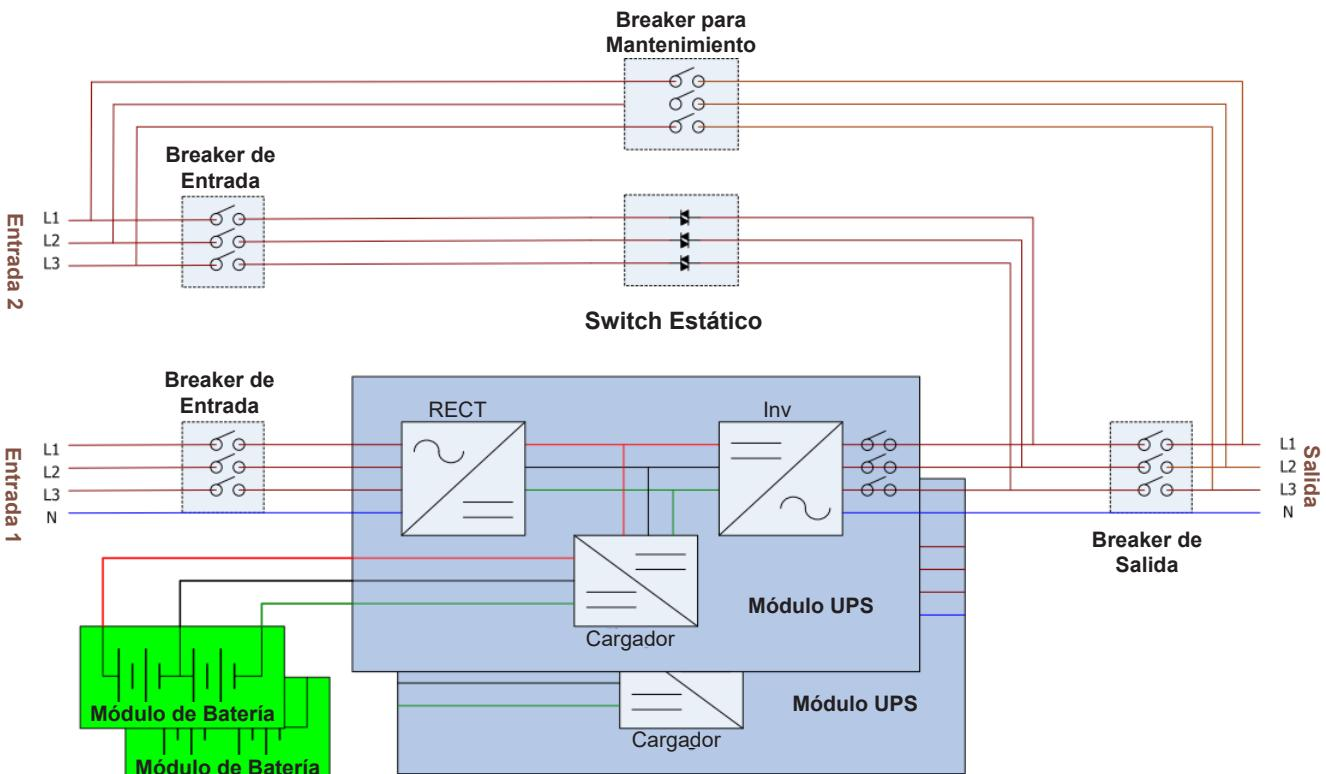
Figura 6.2 Diagrama de Cableado para Entradas Diales (Ofrecido en un Modelo de UPS S3MX Diferente)
