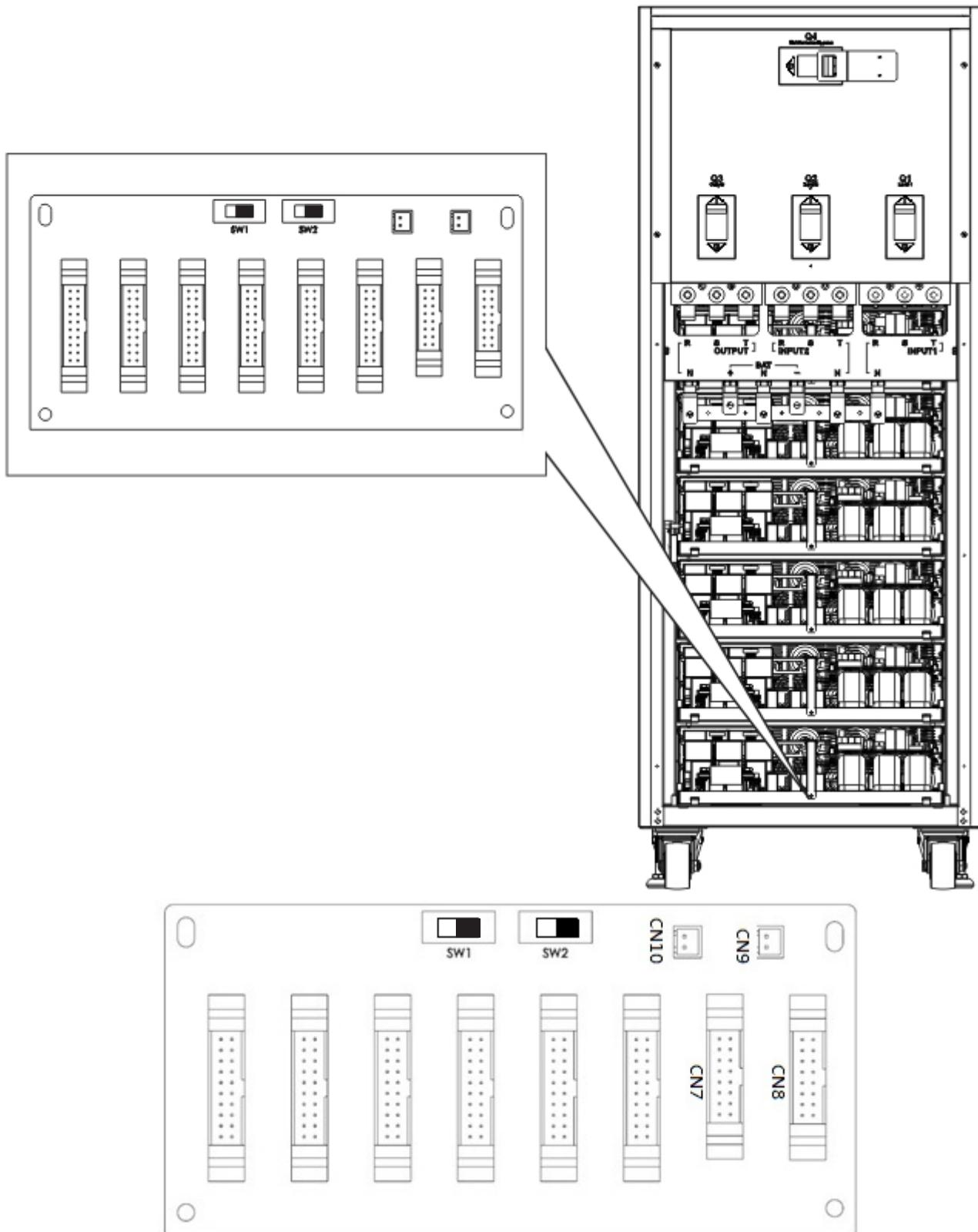
Figura 3.8 Posición del SW2 en UPS 1 (Ajuste Predeterminado)
