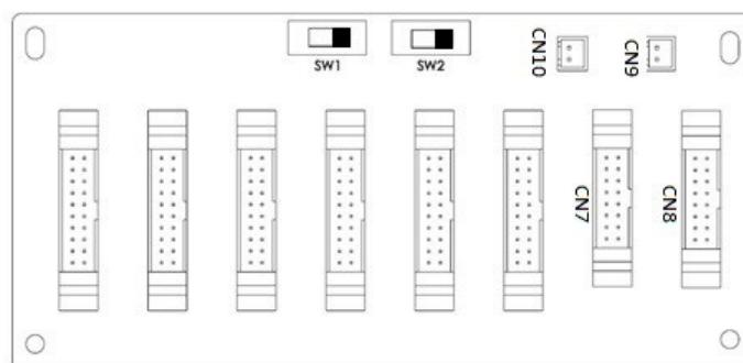
Abbildung 3.10 UPS 1 Parallelplatine
