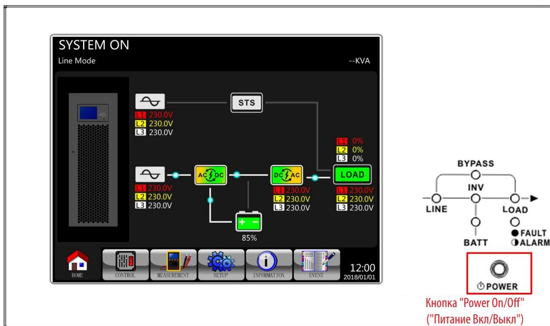
После выключения ИБП он переходит в режим ожидания или режим работы по обходной цепи (в зависимости от настройки разрешения режима работы по обходной цепи).
