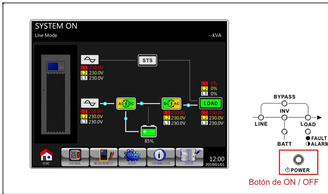
Después de apagar el UPS, el UPS se transferirá a modo En Espera o Modo en Derivación, dependiendo de la configuración de Modo en Derivación.
