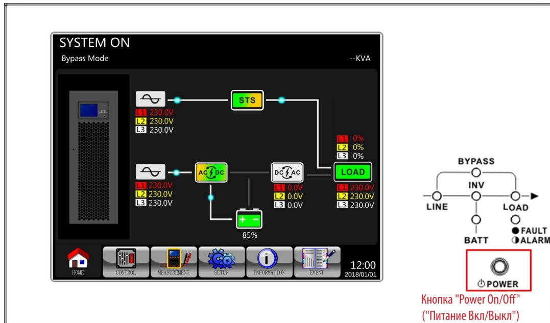
Шаг 7. Нажать кнопку Power ON/OFF (Питание ВКЛ/Выкл) и удерживать ее в течение 2 секунд до включения звукового сигнала, а затем отпустить кнопку для запуска преобразователя.
