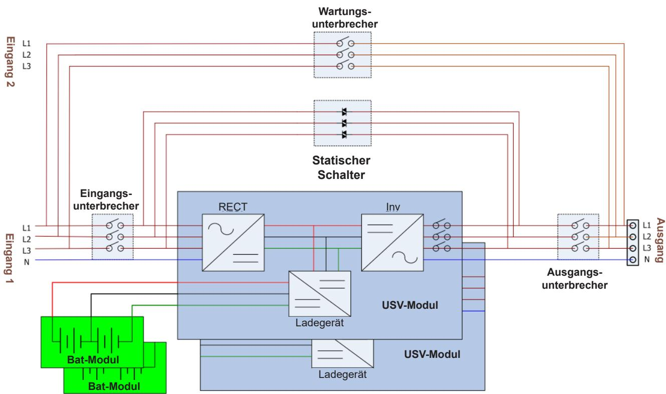
Abbildung 6.1 Schaltplan für eine Standard-Einzeleingangs-USV
