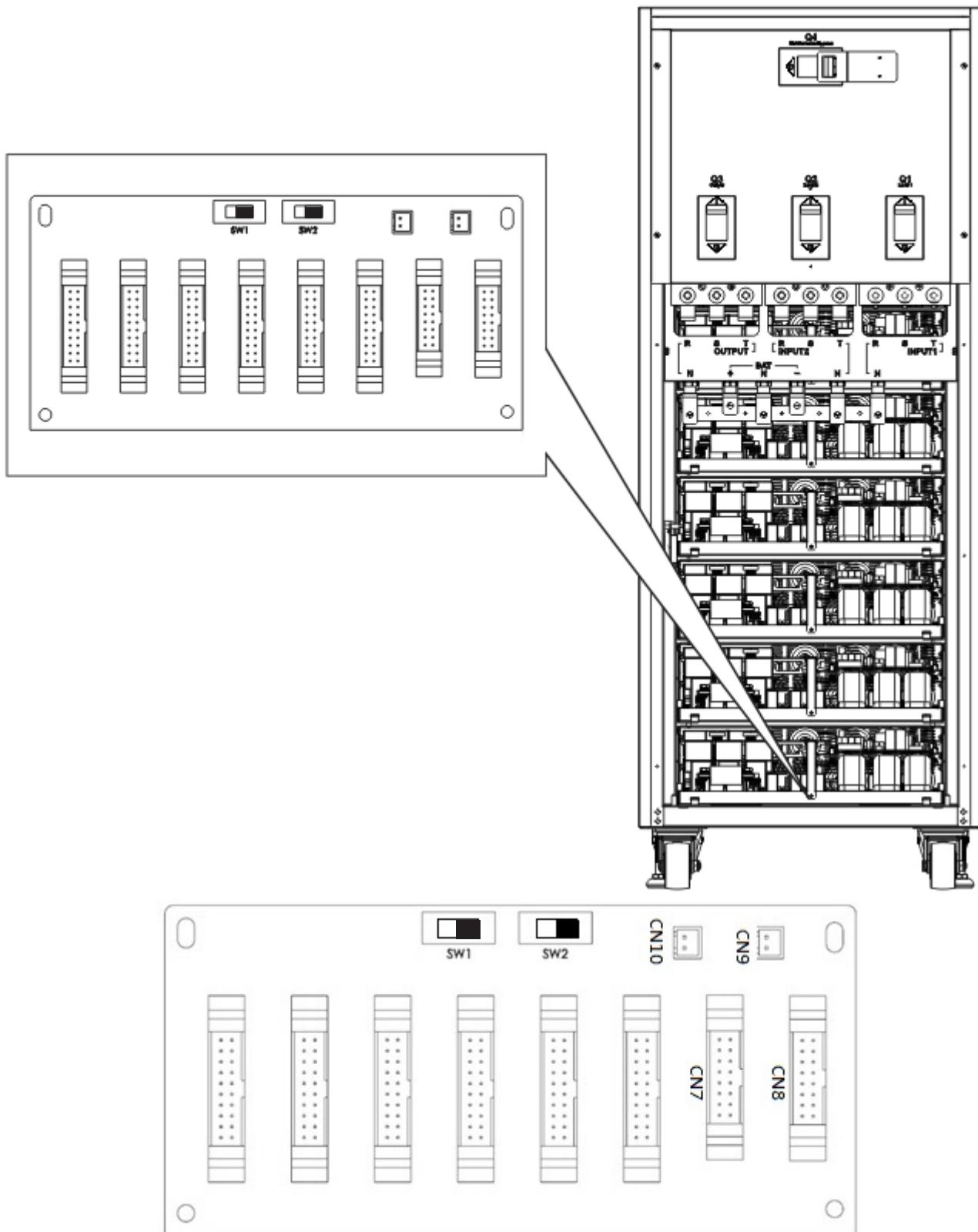
Рис. 3.8 Положение переключателя SW2 в ИБП 1 (настройка по умолчанию)
