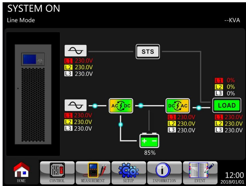
Schritt 8: Die USV ist jetzt im Netzmodus. Der Netzstart ist jetzt abgeschlossen.
