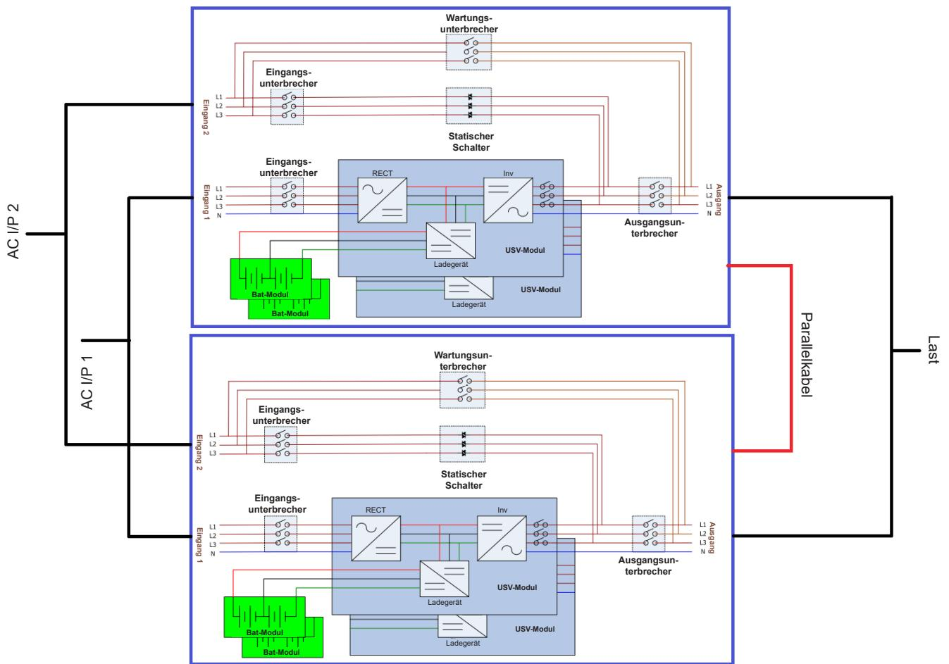
Abbildung 3.7 Für dualen Eingang Modelle in parallelem System
