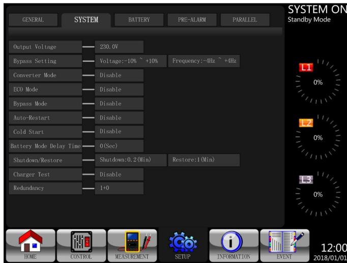
Figure 4.14 Écran de configuration du système
