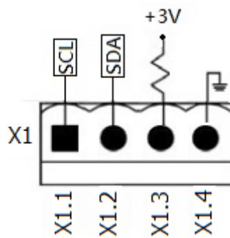
Abbildung 5.2 Anschluss Batterietemperaturdetektor
