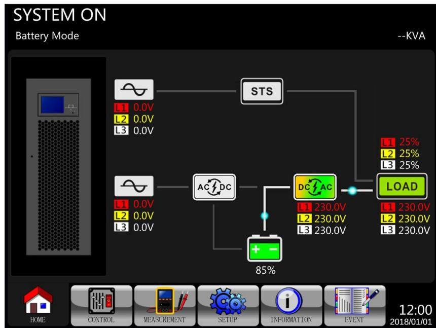
Paso 1: Para apagar el UPS presione el botón de "ON / OFF" durante 2 segundos o use el Menú-Control-Sistema Apague para apagar el UPS.
