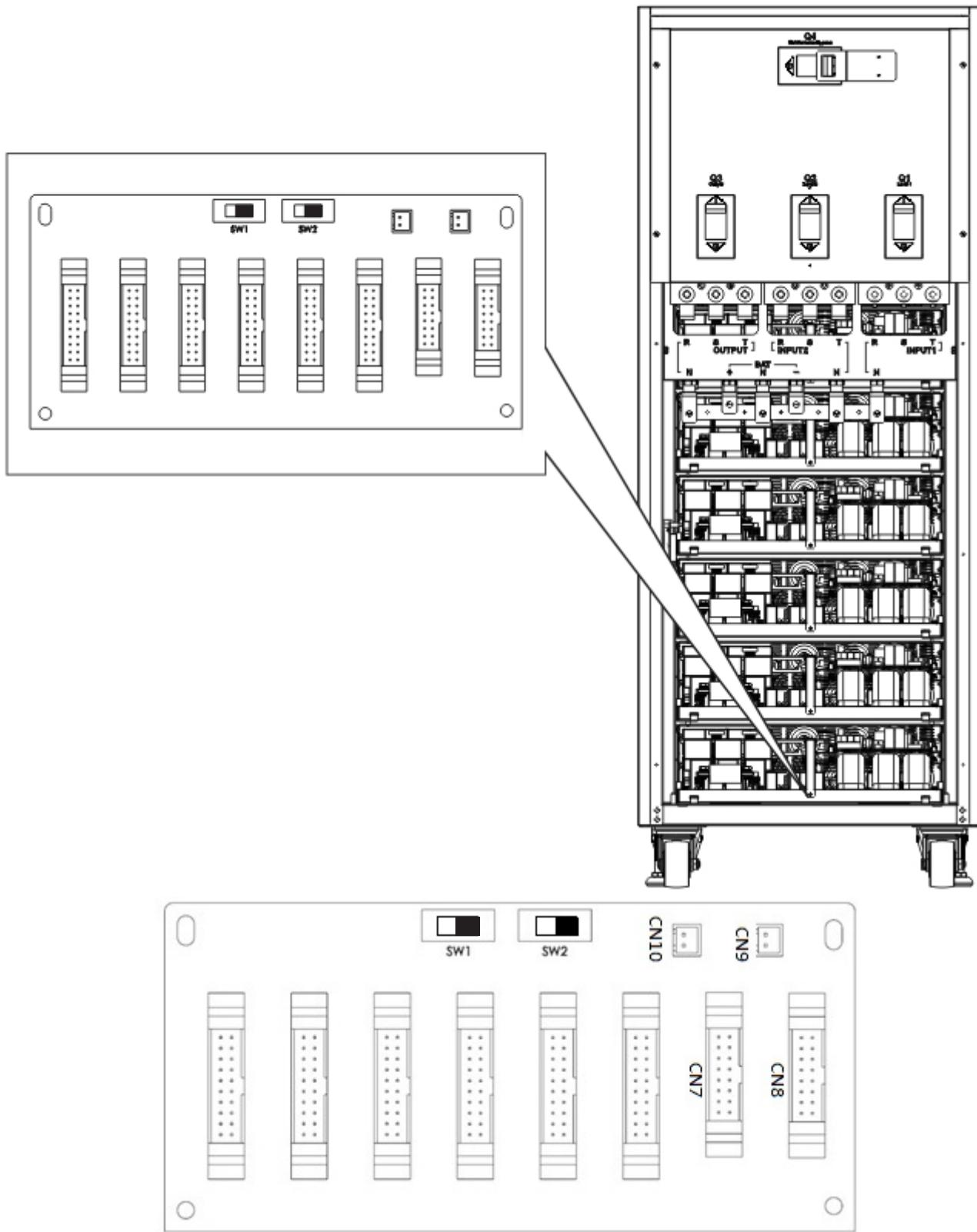
Figure 3.8 Position du SW2 sur l'onduleur 1 (configuration par défaut)
