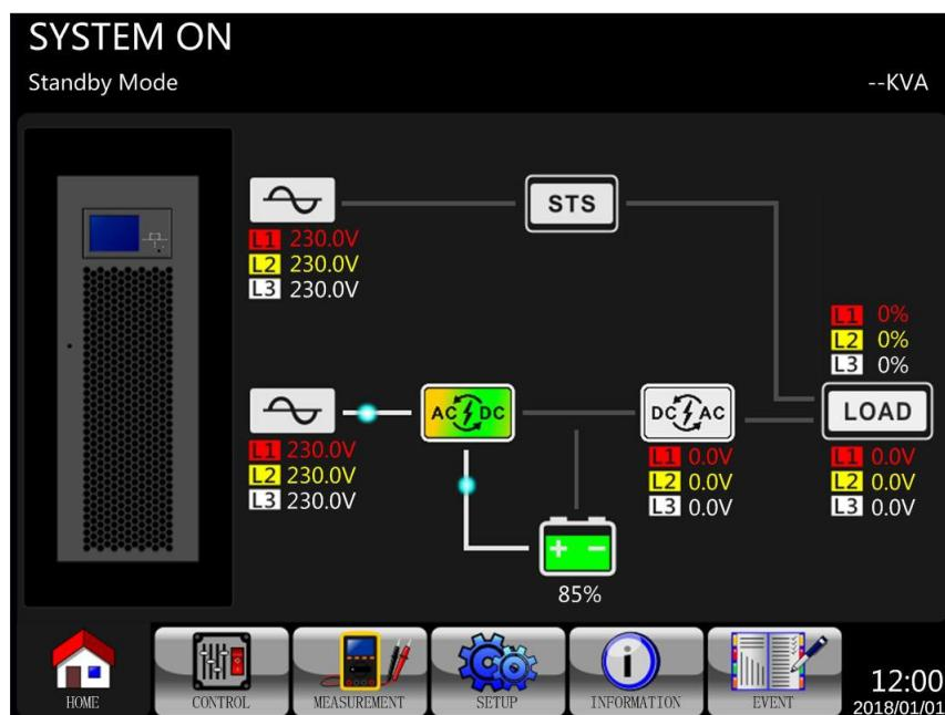
Шаг 4. Выждать одну минуту. На ЖК-дисплее отображается информация, представленная ниже. ИБП переходит в режим работы по обходной цепи, если этот режим разрешен (данная настройка установлена по умолчанию). Если режим работы по обходной цепи запрещен, то ИБП остается в режиме Standby (Ожидание).
