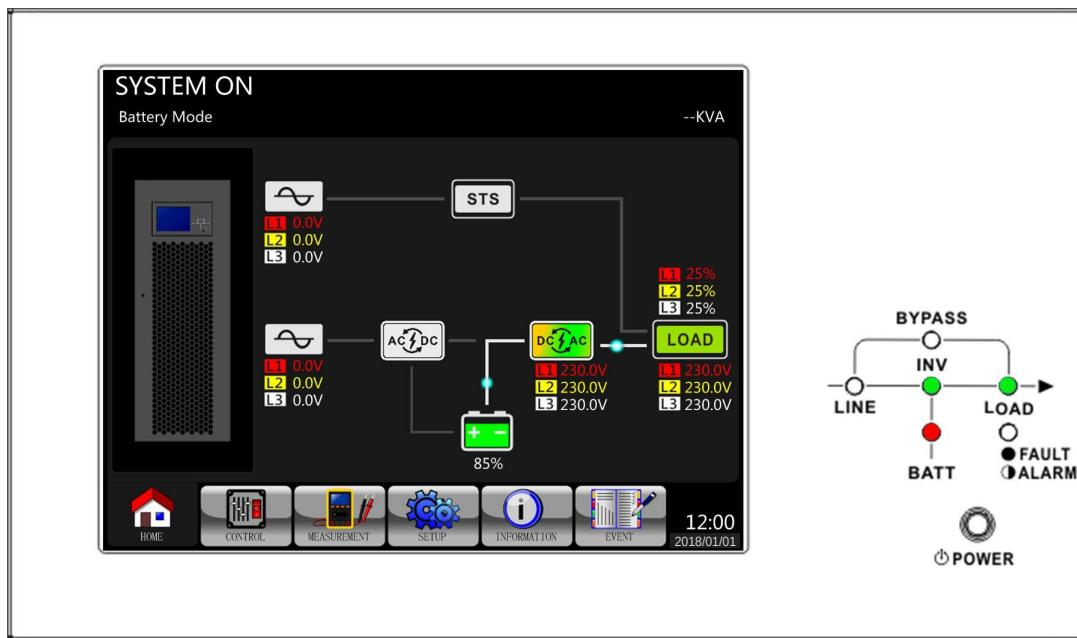
Schritt 6: Schalten Sie den Ausgangsunterbrecher EIN (Q3). Der Kaltstartvorgang ist abgeschlossen.
