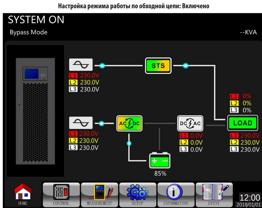
Шаг 2. Перевести входной автоматический выключатель Q1 в положение "OFF" ("Выкл").
