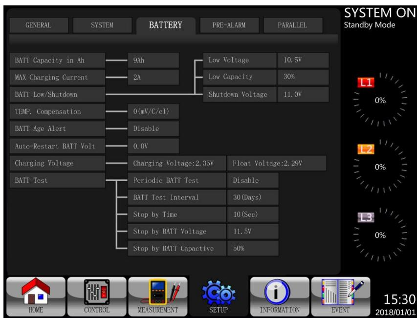
Abbildung 4.16 Bildschirm Battereeinrichtung
