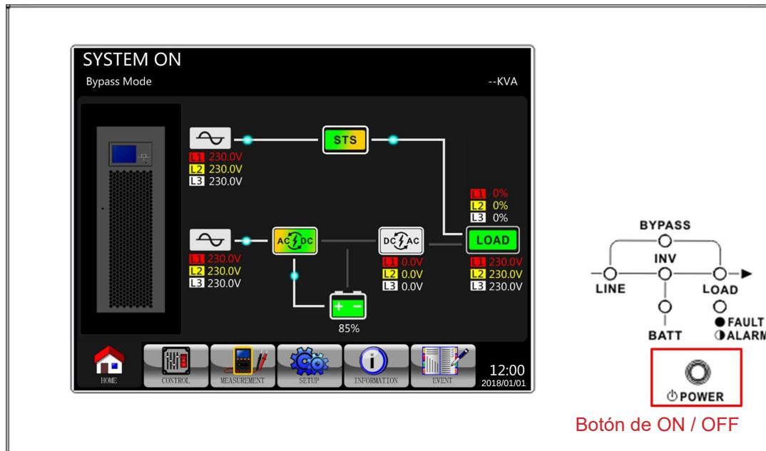
Paso 7: Oprima el botón ON / OFF durante dos segundos hasta que oiga un pitido, a continuación, suelte para arrancar el inversor.
