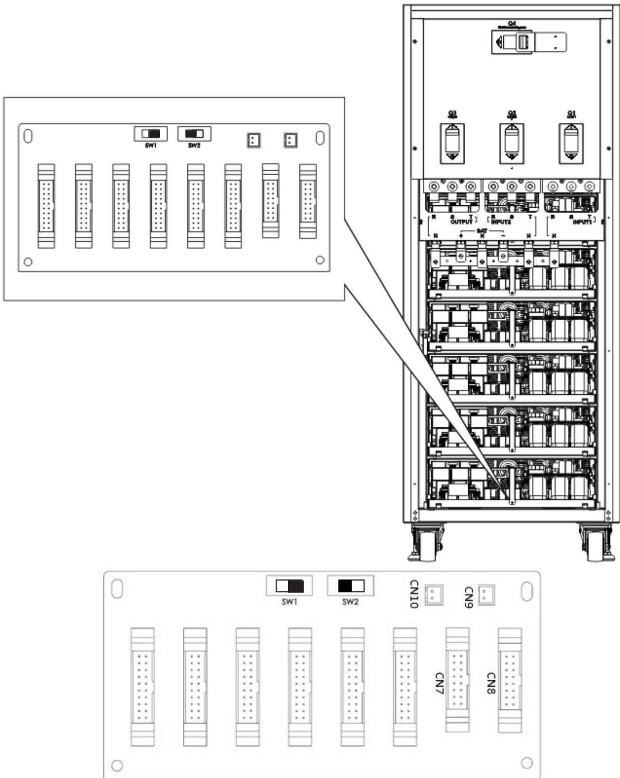
Figure 3.9 Position du SW2 sur l'onduleur 2
