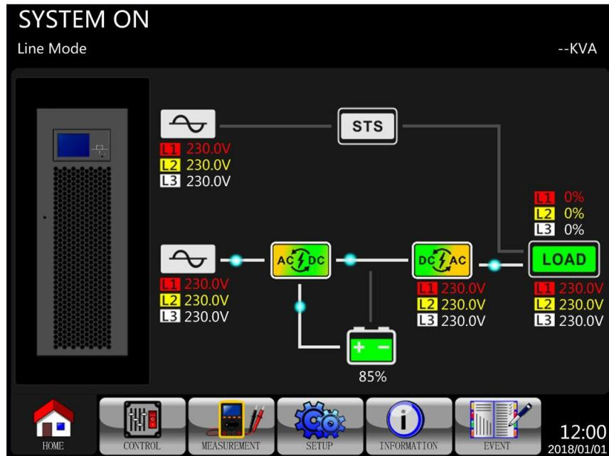
Paso 1: Para apagar el UPS presione el botón de "ON / OFF" durante 2 segundos hasta que escuche un pitido o use el Menú-Control-Sistema
