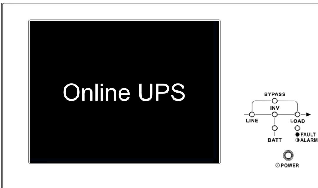
Шаг 4. Сразу после появления экрана Online (Он-лайн) на дисплее ИБП нажать на кнопку "Power On/Off" ("Питание ВКЛ/Выкл") и удерживать ее в течение 2 секунд до включения звукового сигнала, а затем отпустить кнопку для запуска преобразователя.
