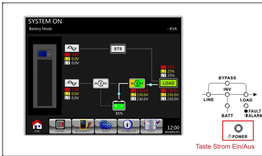
Wenn die USV ausgeschaltet ist, geht die USV in den Standby-Modus über.
