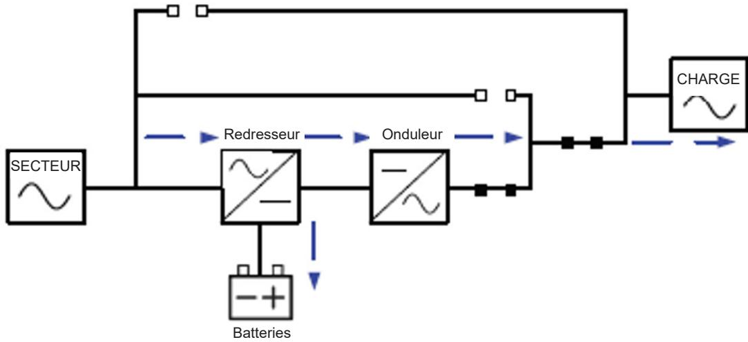
Schéma du mode Conversion de fréquence
