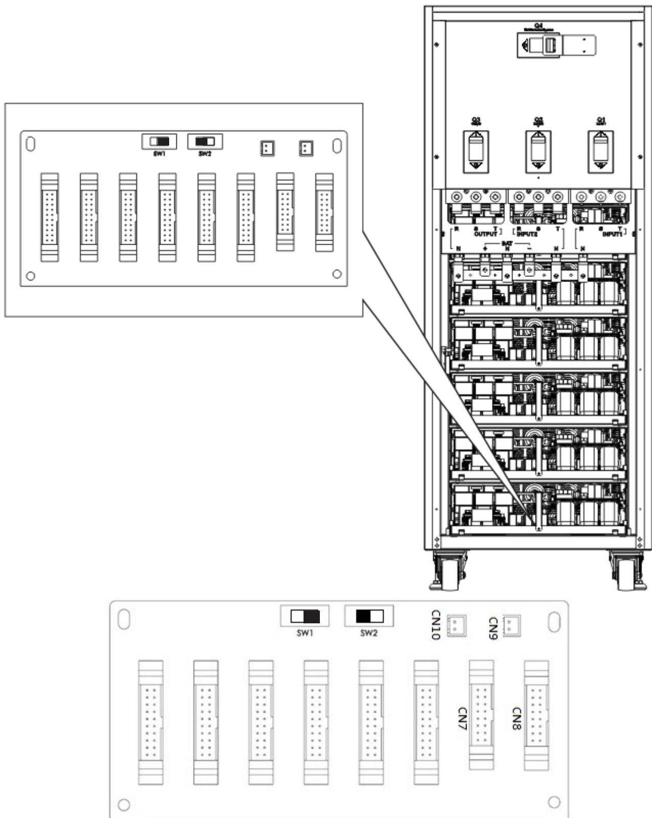
Figura 3.9 Posición del SW2 en UPS 2
