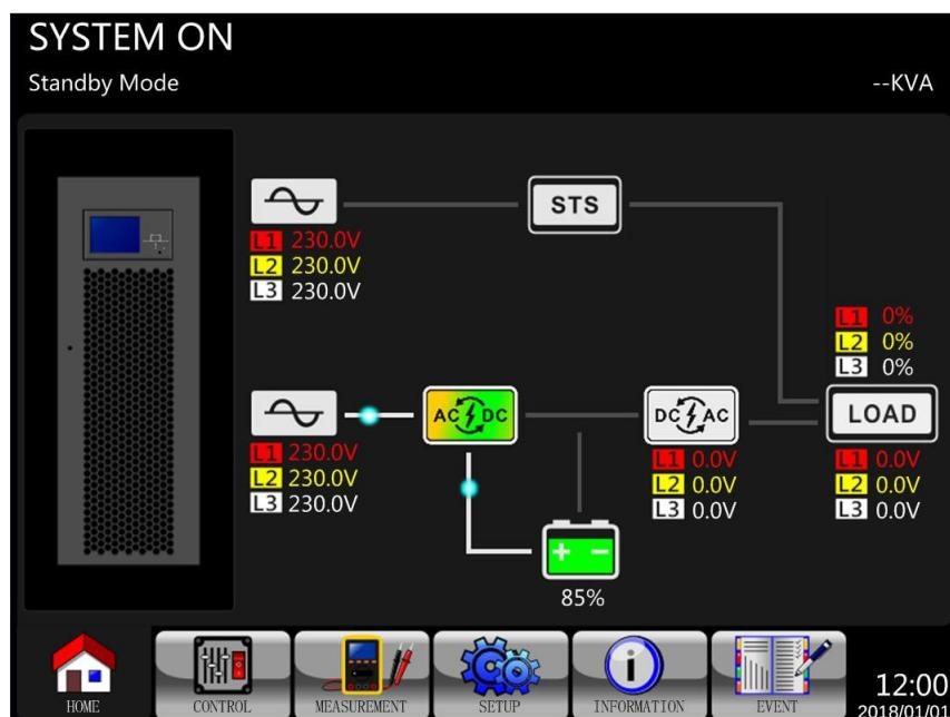
Schritt 4: Warten Sie eine Minute. Das LCD-Panel wird wie unten abgebildet gezeigt. Die USV geht in den Bypass-Modus über, wenn die Einstellung des Bypass-Modus aktiviert ist (Standardeinstellung). Wenn der Bypass-Modus deaktiviert ist, bleibt die USV im Standby-Modus.
