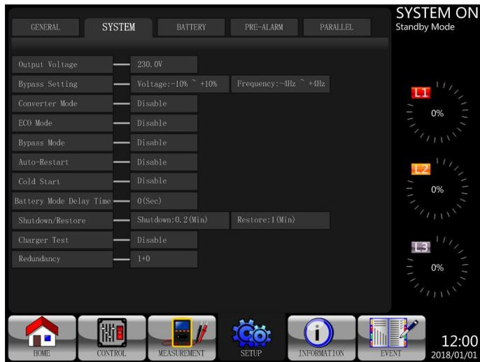
Figure 4.14 Setup-System Screen
