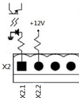
Figura 5.3 Puerto de Entrada de EPO Remoto
