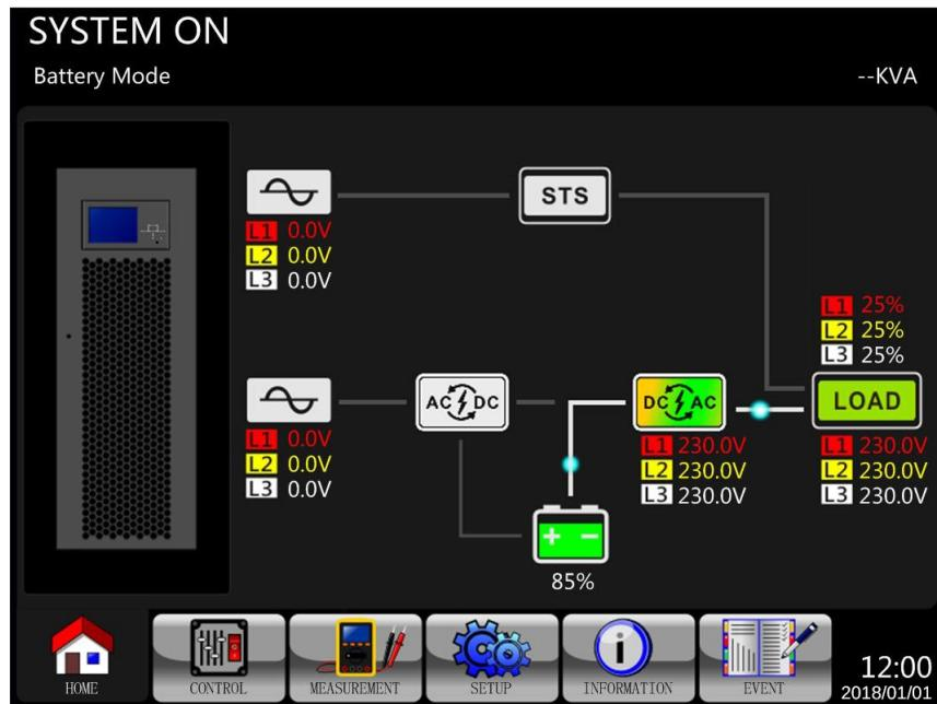
Шаг 1. Нажать на кнопку "Power On/Off" ("Питание Вкл/Выкл") и удерживать ее в течение 2 секунд до выключения ИБП или нажать на ЖК-дисплее Menu-Control-System Turn Off (Меню-Управление-Выключение системы) для выключения ИБП.
