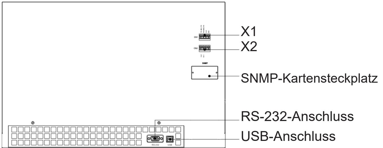
Abbildung 5.1 Potenzialfreie Kontakte und Kommunikationsanschlüsse
