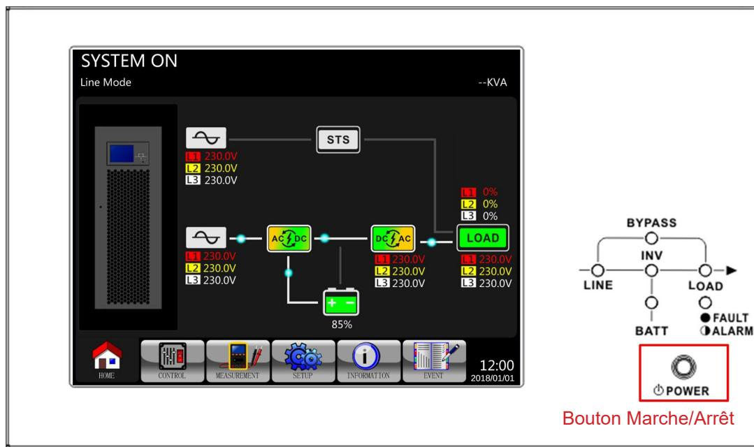
Une fois l'onduleur mis hors tension, l'onduleur passera en mode Veille ou Dérivation, en fonction du paramètre du mode Dérivation.
