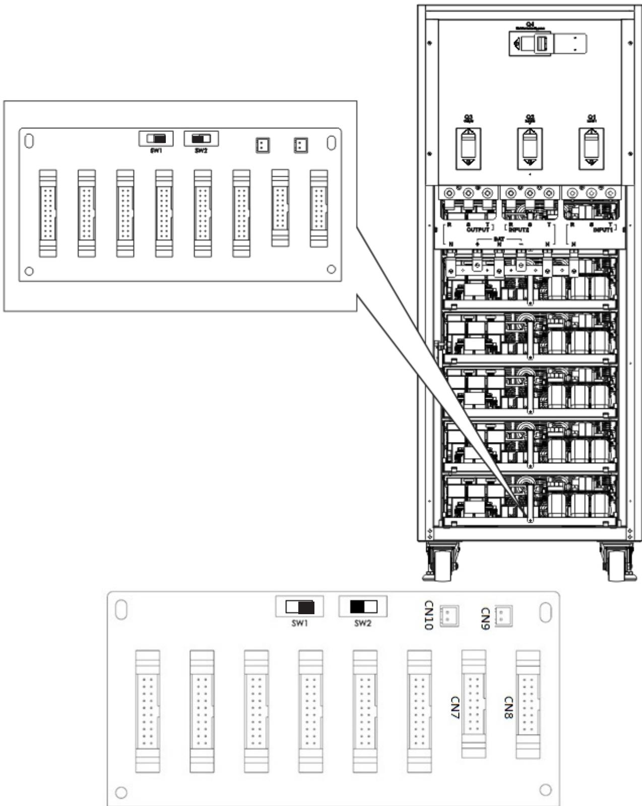
Рис. 3.9 Положение переключателя SW2 в ИБП 2
