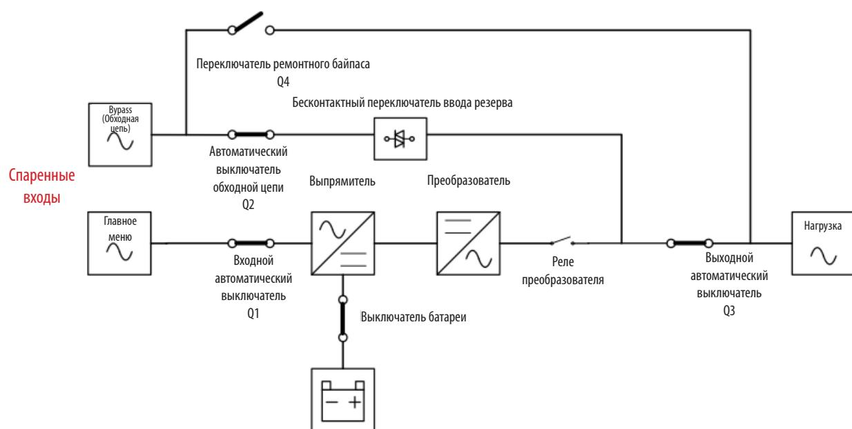
Схемы работы в режиме отключения
