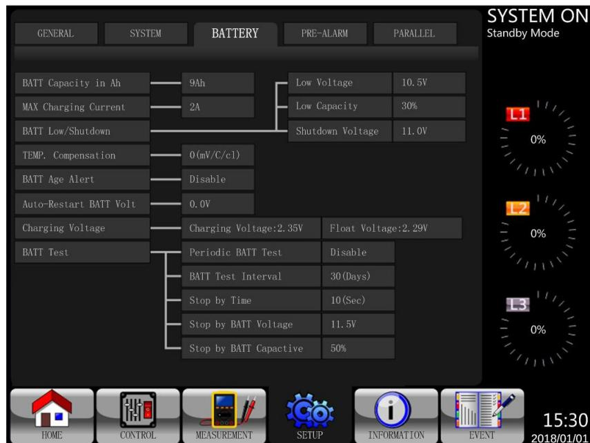
Figure 4.16 Écran de configuration de la batterie
