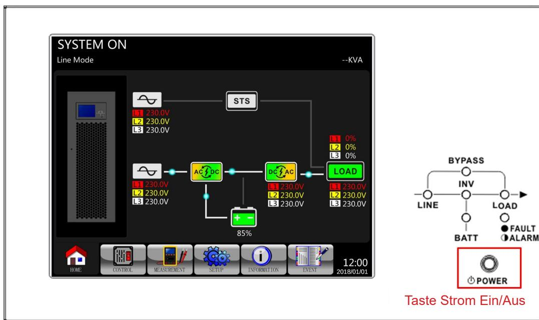
Nachdem Sie die USV ausgeschaltet haben, geht die USV in den Standby-Modus oder den Bypass-Modus über, abhängig von der Bypass-Modus-Einstellung.
