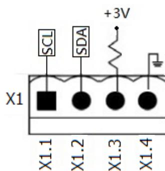
Figura 5.2 Puerto de Detección de Temperatura de la Batería
