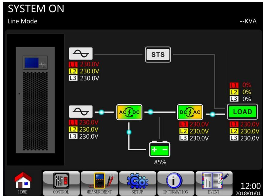
Шаг 1. Нажать на кнопку "Power On/Off" ("Питание Вкл/Выкл") и удерживать ее в течение 2 секунд до срабатывания звукового сигнала или нажать на ЖК-дисплее Menu-Control-System Turn Off (Меню-Управление-Выключение системы) для выключения ИБП.
