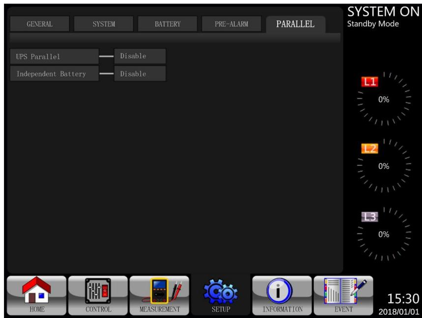
Рис. 4.18. Экран Setup Parallel (Начальная установка — Параллельное подключение)
