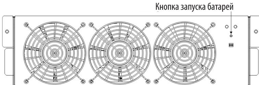
Шаг 3. После нажатия кнопки "Battery Start" ("Запуск батареи") на дисплее ИБП отображается экран инициализации.
