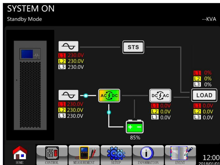
Paso 4: Espere un minuto El panel LCD se despliega tal como se muestra a continuación. El UPS entrará en Modo en Derivación si está habilitada la configuración de Modo en Derivación (configuración predeterminada). Si se deshabilita el Modo en Derivación, el UPS permanecerá en modo de espera.
