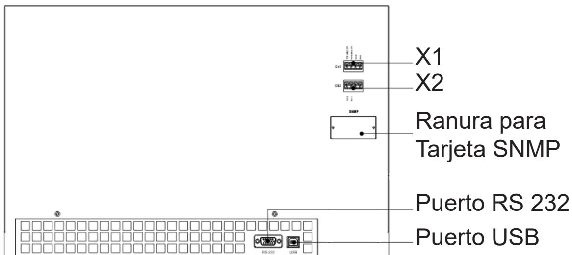
Figura 5.1 Puerto de Contactos Secos y Puerto de Comunicación
