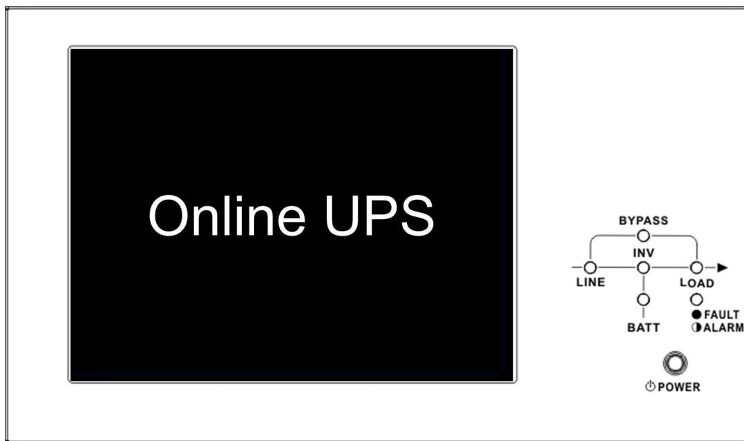
Paso 4: Mientras el UPS esté mostrando la pantalla en línea, oprima inmediatamente el botón de "ON / OFF" durante 2 segundos hasta oír un pitido y suelte para arrancar el inversor.
