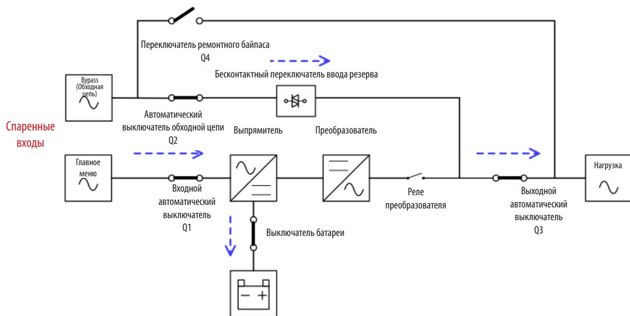
Схемы функционирования в режиме работы по обходной цепи
