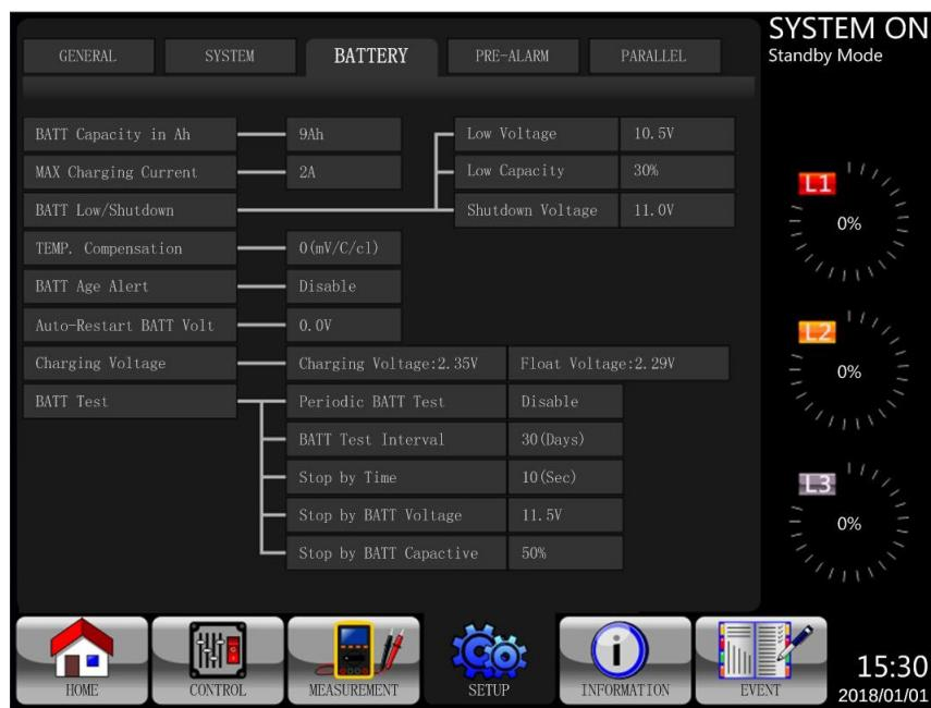
Рис. 4.16 Экран Setup-Battery (Начальная установка — Батарея)
