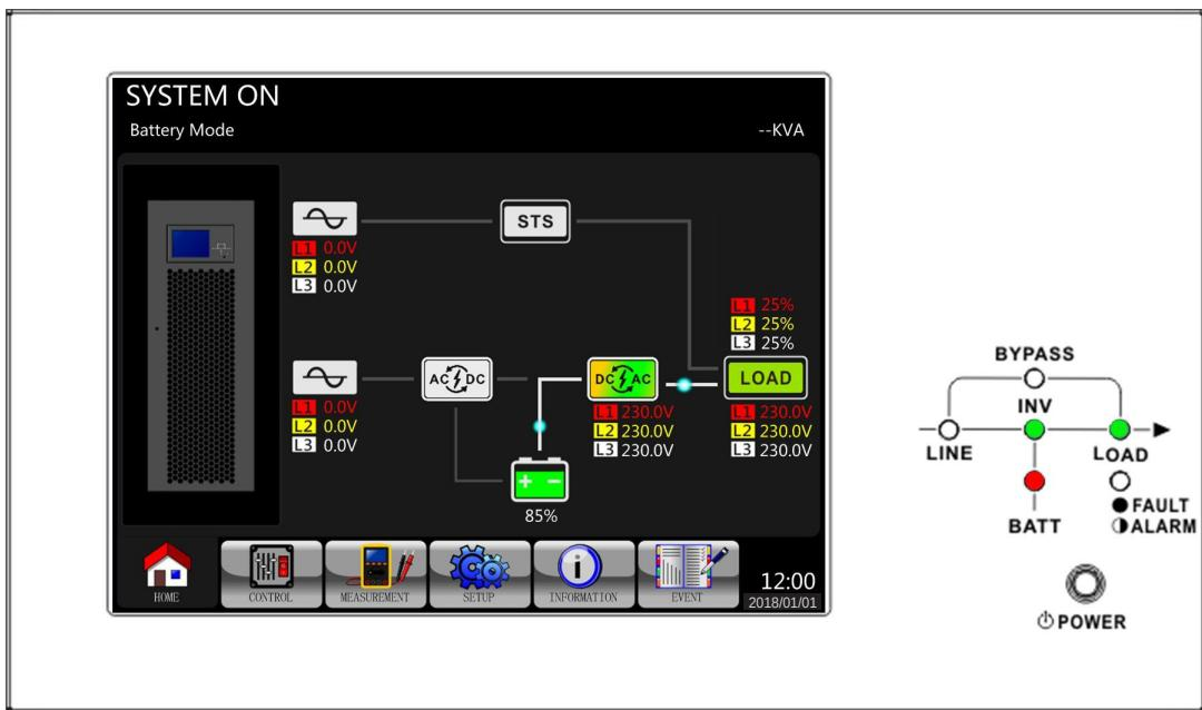
Étape 6 : Activez le disjoncteur de sortie (Q3). La procédure de démarrage à froid est terminée.
