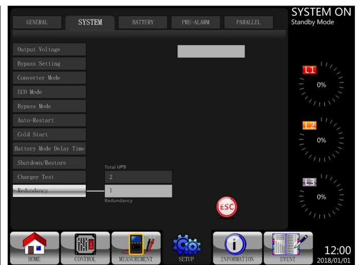
Рис. 4.20 Резервирование между двумя модулями
