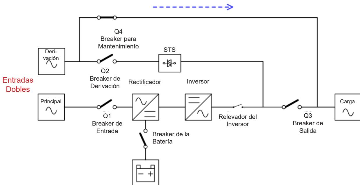
Diagramas de Modo en Derivación para Mantenimiento
