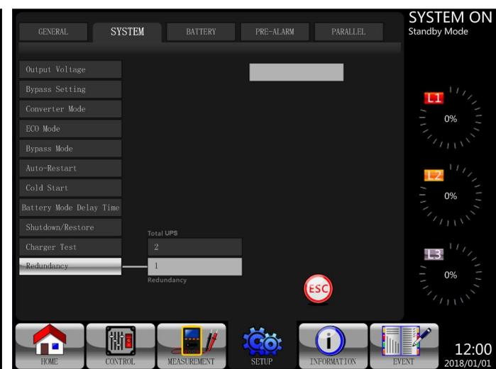
Figura 4.20 Redundancia a Través de Dos Unidades
