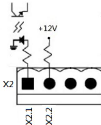
Abbildung 5.3 Remote-EPO-Eingangsanschluss
