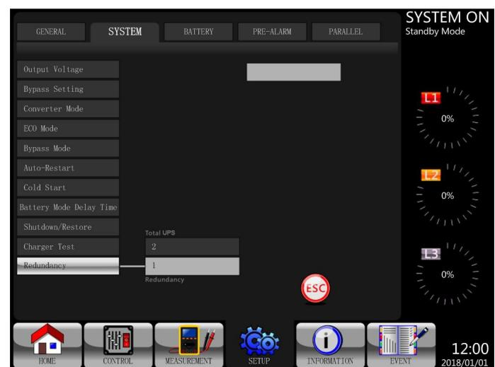
Abbildung 4.20 Redundanz auf zwei Einheiten
