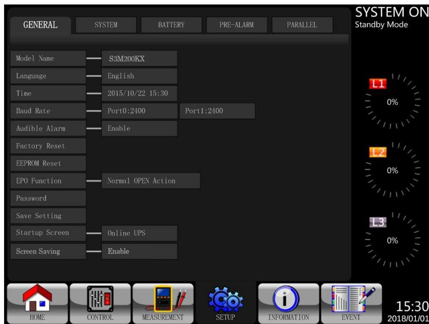
Рис. 4.13. Экран Setup-General (Начальная установка — Общие настройки)
