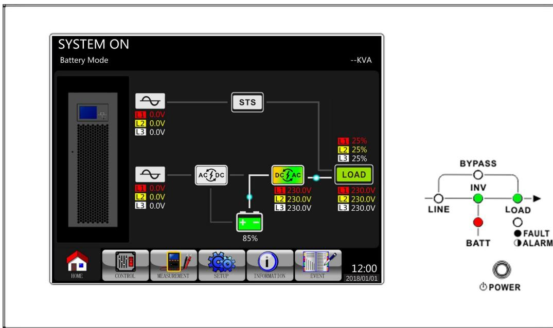
Paso 6: Encienda el breaker de salida (Q3). El procedimiento de Arranque en Frío está completo.
