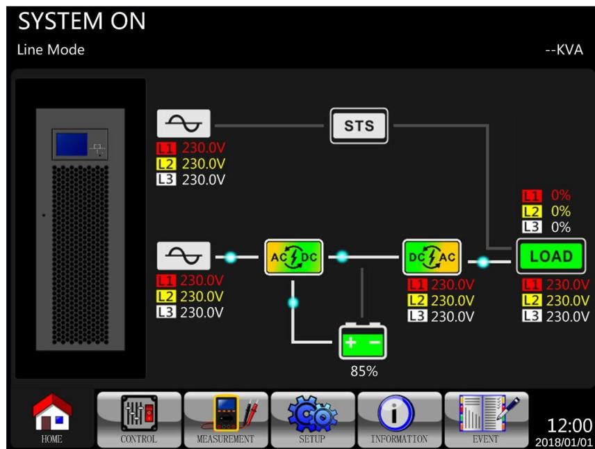
Schritt 1: Drücken Sie die Taste „Strom Ein/Aus“ zwei Sekunden lang, bis ein Piepton zu hören ist, um die USV auszuschalten, oder verwenden Sie das Menüsteuerungssystem.
