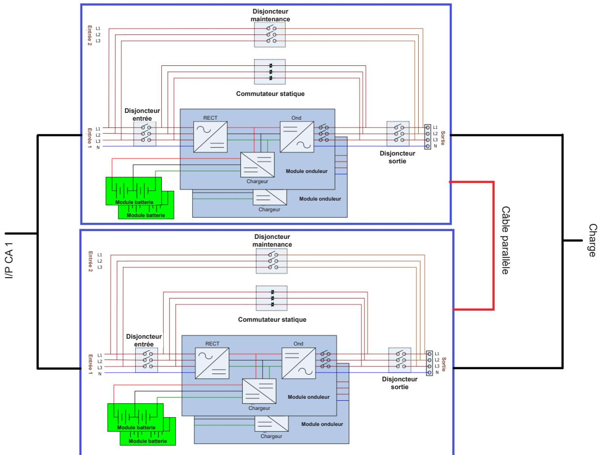
Figure 3.6 Câblage d'entrée simple en système parallèle
