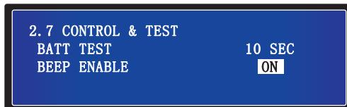
1. **TEST BATT** : Active ou désactive le test des batteries. Trois choix sont possibles : **ANNULER**, **PROFOND** ou **10 SEC**.
