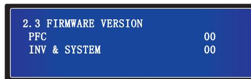
На представленном выше экране отображаются условное обозначение используемой технологии преобразования с коррекцией коэффициента мощности (PFC) и номер версии прошивки ПРЕОБРАЗОВАТЕЛЯ И СИСТЕМЫ.
