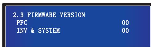
La pantalla anterior muestra la versión del firmware de PFC y de INVERSOR Y SISTEMA.
