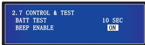
**1. PRUEBA DE BATERÍA:** Activa o desactiva la prueba de la batería. Existen tres opciones: **ABORTAR**, **PROFUNDA** o **10 SEG.**
