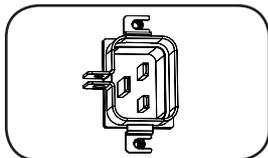
**Входной разъем питания (для отдельных моделей):** входной разъем питания типа IEC подключается к поставляемому в комплекте шнуру питания или к пользовательскому шнуру питания, совместимому с ним. Для фиксации подсоединенного шнура питания входной разъем оснащен специальным кронштейном.
