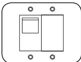
**Disjoncteurs (modèles sélectionnés) :** Si la charge de l'équipement branché sur le groupe de charge excède la charge nominale maximale du groupe, le disjoncteur se déclenchera. Débranchez l'équipement en trop et commutez le disjoncteur à la position ON (MARCHE) pour réinitialiser celui-ci. Les modèles équipés de plusieurs groupes de sortie ont un disjoncteur pour chaque groupe. Les disjoncteurs sont utilisés uniquement pour protéger les groupes de charge de sortie.
