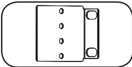
**Installationshalterungen:** Verwenden Sie diese Halterungen zum Einbau der PDU.
