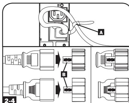
(Option 2) Utiliser les inserts enfichables-verrouillables C14 et C20 inclus pour retenir les fiches aux prises de courant. Fixer l'insert dans la fiche en s'assurant que les languettes de préhension **B** demeurent à l'extérieur de la fiche et qu'il repose solidement en place. Pour débrancher correctement l'équipement, utiliser les languettes de préhension pour retirer la fiche et l'insert de la prise de courant.
