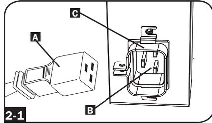
**Hinweis:** Optional kann ein benutzerseitig bereitgestelltes Netzkabel über den IEC-Eingang an die PDU angeschlossen werden. Versuchen Sie nicht, ein benutzerseitig bereitgestelltes Netzkabel anzuschließen, es sei denn, es ist mit der von der PDU verwendeten Eingangsstromquelle kompatibel.
