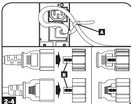
(Вариант 2) Зафиксируйте вилки в розетках при помощи входящих в комплект вставок для фиксации разъемов C14 и C20. Наденьте вставку на вилку, убедившись в том, что язычки **B** остались снаружи, а также в плотном прилегании муфты. Для правильного отключения оборудования от источника питания вынимайте вилку со вставкой из розетки, держась за язычки.
