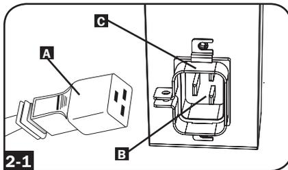
**Примечание.** При желании пользователь может подключить PDU при помощи своего собственного шнура питания, вставляемого во входной разъем типа IEC. Не следует производить подключение с помощью пользовательского шнура питания, не сертифицированного на совместимость с источником питания, используемым на входе PDU.
