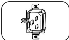
**Embase d'alimentation (certains modèles) :** L'embase d'alimentation CEI se connecte au cordon d'alimentation fourni ou à un cordon d'alimentation compatible fourni par l'utilisateur. L'embase dispose d'une bride pour assurer la connexion du cordon.
