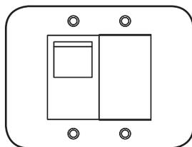
**Trennschalter (ausgewählte Modelle):** Überschreitet die angeschlossene Gerätelast einer Lastbank den maximalen Lastwert der Lastbank, wird der Trenn- bzw. Leistungsschalter ausgelöst. Trennen Sie überschüssige Ausrüstung und schalten Sie den Trennschalter in die Stellung EIN, um diesen zurückzusetzen. Modelle mit mehreren Steckdosenreihen verfügen über einen Trennschalter für jede Reihe. Trennschalter werden nur zum Schutz der Ausgangslastbänke verwendet.
