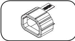
**C14-Steckverriegelungseinsätze (optional):** Verwenden Sie die mitgelieferten C14-Steckverriegelungseinsätze, um die Stecker an den Buchsen zu sichern. Bringen Sie die Muffe am Stecker an und stellen Sie sicher, dass die Zuglaschen außerhalb des Steckers bleiben und die Passung sicher ist. Um das Gerät ordnungsgemäß vom Netz zu trennen, entfernen Sie Stecker und Einsatz mithilfe der Zuglaschen aus der Steckdose.
