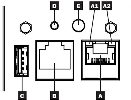
**A Port Ethernet :** Utiliser cette prise RJ45 pour connecter la WEBCARDLX au réseau avec un cordon de raccordement Ethernet standard. Voyants à DEL **A1** et **A2** indiquent les conditions de fonctionnement (affichées dans le tableau ci-dessous).
