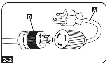
**2-3** Включите входной разъем в совместимую с ним розетку электропитания переменного тока. Если PDU не имеет автоматического выключателя, то его следует оснастить устройством защиты от перегрузок по току в соответствии с параметрами цепи питания, согласованным с номинальной амперной нагрузкой PDU.
