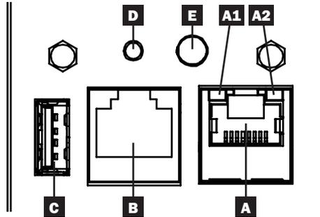
**A Puerto Ethernet:** El conector RJ45 conecta la tarjeta WEBCARDLX a la red usando un cable patch estándar de Ethernet. Los LEDs **A1** y **A2** indican las condiciones de operación (se muestra en la siguiente tabla).
