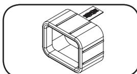
**Inserts enfichables-verrouillables C20 (en option) :** utiliser les inserts enfichables-verrouillables C20 inclus pour retenir les fiches aux prises de courant C19. Fixer le manchon à la fiche en s'assurant que les languettes de préhension demeurent à l'extérieur de la fiche et qu'il repose solidement en place. Pour débrancher correctement l'équipement, utiliser les languettes de préhension pour retirer la fiche et l'insert de la prise de courant.
