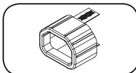
**Inserts enfichables-verrouillables C14 (en option) :** utiliser les inserts enfichables-verrouillables C14 inclus pour retenir les fiches aux prises de courant C13. Fixer le manchon à la fiche en s'assurant que les languettes de préhension demeurent à l'extérieur de la fiche et qu'il repose solidement en place. Pour débrancher correctement l'équipement, utiliser les languettes de préhension pour retirer la fiche et l'insert de la prise de courant.
