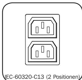
**Steckdosen (je nach Modell unterschiedlich):** Während des normalen Betriebs verteilen die Steckdosen den Wechselstrom auf die angeschlossenen Geräte. Ausgewählte Modelle verfügen über eine LED-Leuchte, die den Ausgangsstatus anzeigt.
