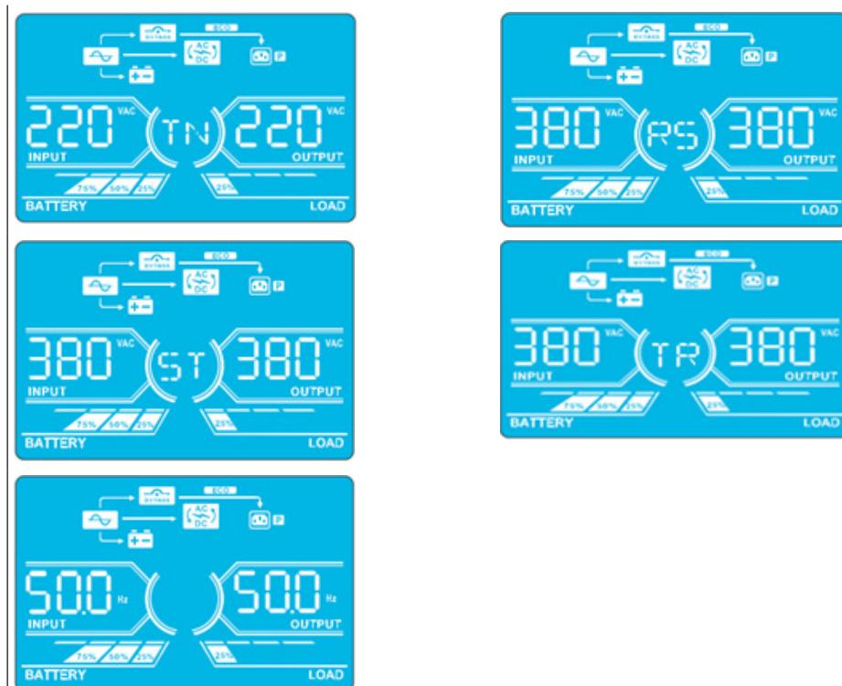
Modo CVCF      Descripción      Cuando la frecuencia de salida esté configurada en "CF", el inversor entregará frecuencia constante (50Hz o 60Hz). En este modo, el UPS no tendrá salida en derivación, pero permanecerá cargando la batería.
