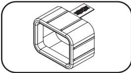
**Муфта разъема C20 (опция):** зафиксируйте разъемы в розетках при помощи входящих в комплект пластмассовых муфт под разъемы C20. Прикрепите муфту к разъему, убедившись в том, что ее язычки остаются за пределами разъема и плотно прилегают к нему. Для правильного отсоединения оборудования следует вынимать разъем с муфтой из розетки, держа за язычки.
