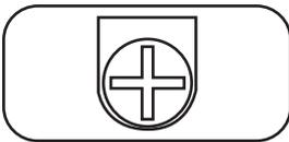
**Провод заземления:** используется для соединения с любым оборудованием, требующим заземления шасси.
