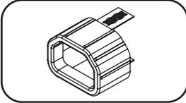
**Manchons de fiche C14 (facultatif) :** Utiliser les manchons en plastique C14 inclus pour retenir les fiches aux prises de courant. Fixer le manchon à la fiche en s'assurant que les languettes de préhension demeurent à l'extérieur de la fiche et qu'il repose solidement en place. Pour débrancher correctement l'équipement, utiliser les languettes de préhension pour retirer la fiche et le manchon de la prise de courant.
