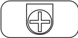
**Conexión a Tierra:** Úselo para conectar cualquier equipo que requiera una conexión de tierra a chasis.
