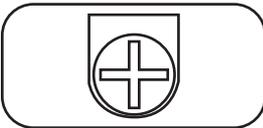
**Connexion à la terre :** Utiliser pour raccorder de l'équipement nécessitant une mise à la terre au châssis.
