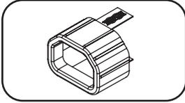
**Муфта разъема C14 (опция):** зафиксируйте разъемы в розетках при помощи входящих в комплект пластмассовых муфт под разъемы C14. Прикрепите муфту к разъему, убедившись в том, что ее язычки остаются за пределами разъема и плотно прилегают к нему. Для правильного отсоединения оборудования следует вынимать разъем с муфтой из розетки, держа за язычки.
