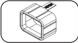
**Manguito de Clavija C20 (Opcional):** Use los manguitos plásticos C20 incluidos para asegurar las clavijas a los tomacorrientes. Acople el manguito a la clavija asegurándose que las pestañas de tiro permanezcan fuera de la clavija y que la sujeción sea segura. Para desenchufar correctamente el equipo, use las pestañas de tiro para retirar la clavija y el manguito del tomacorriente.
