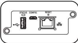
**WEBCARDLX :** Permet d'utiliser cette PDU comme un dispositif géré par le réseau, accessible via la plateforme de gestion de réseau SNMP, un navigateur Web, SSH ou Telnet.
