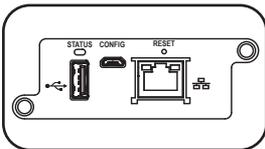
**Карта WEBCARDLX:** обеспечивает возможность эксплуатации данного PDU в качестве управляемого сетевого устройства, доступного через платформу сетевого управления на основе SNMP, веб-браузер, протокол SSH или Telnet.
