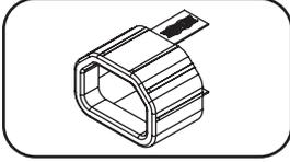
**Manguito de Clavija C14 (Opcional):** Use los manguitos plásticos C14 incluidos para asegurar las clavijas a los tomacorrientes. Acople el manguito a la clavija asegurándose que las pestañas de tiro permanezcan fuera de la clavija y que la sujeción sea segura. Para desenchufar correctamente el equipo, use las pestañas de tiro para retirar la clavija y el manguito del tomacorriente.
