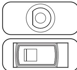
**Breakers de Salida:** Dos breakers (uno por cada banco de carga) protegen al equipo conectado a contra sobrecargas. Si la carga total en cualquiera de los bancos de salida del PDU excede 20 amperes (PDUMH30NET & PDUMH32HVNET) o 15 amperes (PDUMH30HVNET), se disparará el breaker asociado, cortando la energía a todo el banco de salida. Reduzca la carga en el banco de salida desconectando algún equipo, entonces oprima el breaker a la posición ON para restablecer la energía.
