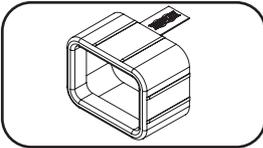
**Manchons de fiche C20 (facultatif) :** Utiliser les manchons en plastique C20 inclus pour retenir les fiches aux prises de courant. Fixer le manchon à la fiche en s'assurant que les languettes de préhension demeurent à l'extérieur de la fiche et qu'il repose solidement en place. Pour débrancher correctement l'équipement, utiliser les languettes de préhension pour retirer la fiche et le manchon de la prise de courant.
