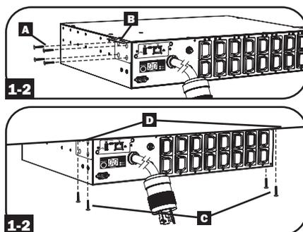
**1-3 Fixation pour les étagères de rétention du cordon (en option) :** Utiliser les vis incluses A pour fixer les étagères de rétention du cordon B à la partie supérieure et à la partie inférieure du panneau avant de la PDU comme illustré.
