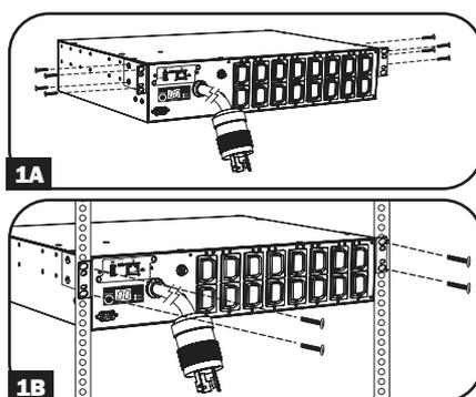
**1-2 Montage sous le comptoir :** Utiliser les 4 vis incluses A pour fixer chacun des 2 supports de montage B à la PDU comme illustré. Monter la PDU sous le comptoir en insérant au moins deux vis fournies par l'utilisateur C à travers les supports de montage D et dans les points de montage solides.
