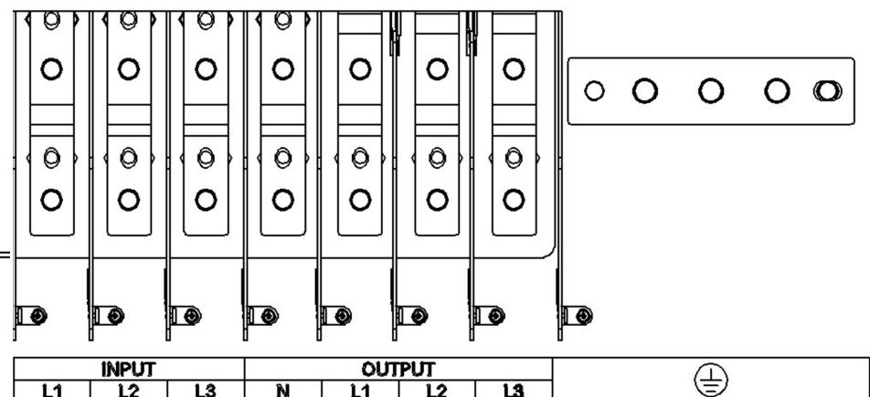
Vue avant (bloc de jonction avec couvercle), S3MT-60K480V/S3MT-60K600V
