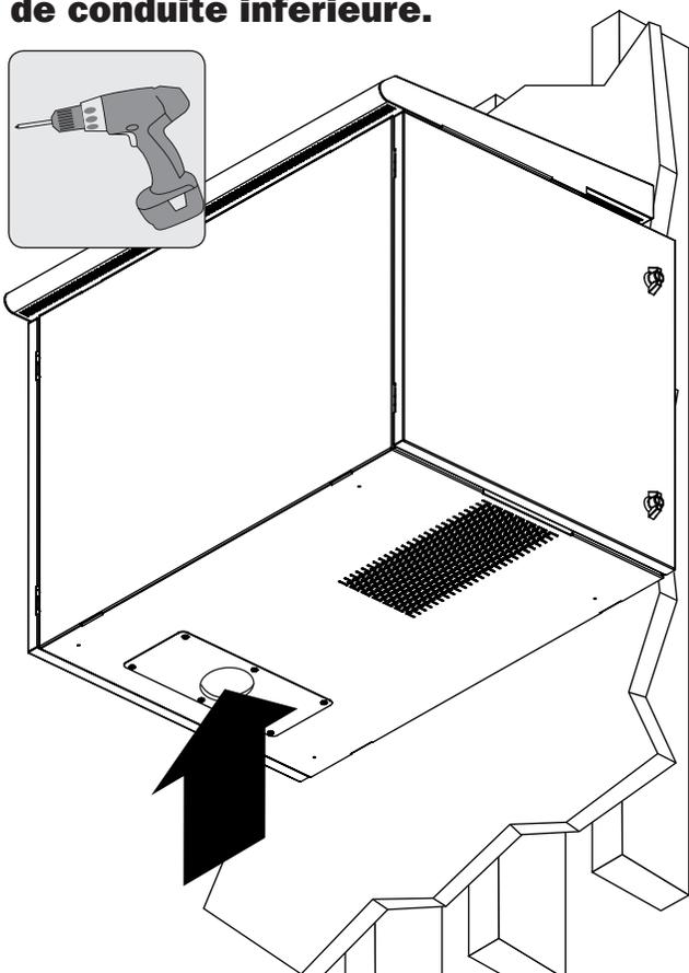
**Remarque :** Ce couvercle de conduit prend en charge un conduit de taille 2 maximum avec un trou de 2,5 po.
