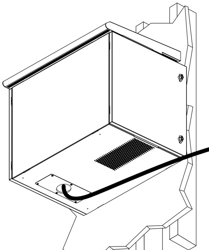
**Remarque :** Pour garder une capacité nominale NEMA, utiliser des raccords étanches dans les coupes au moment de connecter à la conduite. Les plaques passe-câbles pour accessoires avec les numéros de modèle SRGP1KO, SRGP2KO, SRGP3RM et SRGP4PLASTIC sont offertes (vendues séparément).
